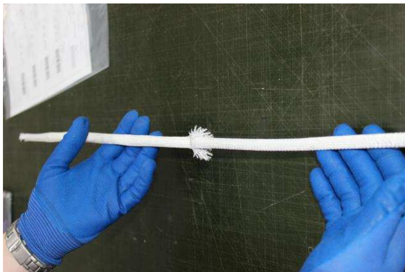
Abbildung 7: Bleiummantelung mit Trockenfaser-Geflechtschlauch
