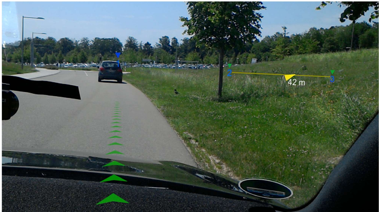
Abb. 52: Die umgesetzte Visualisierung, wie sie durch eine HoloLens aussieht. Die Situation wurde in Renningen mit simulierten Daten erzeugt.
