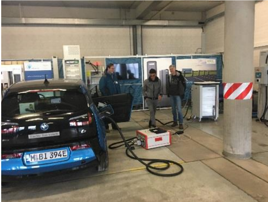
Abbildung 114 Entladen der FastCharge Batterie durch Rückspeisen
