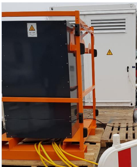
Abbildung 9 Leistungstest mit DC-Wirklastbank
