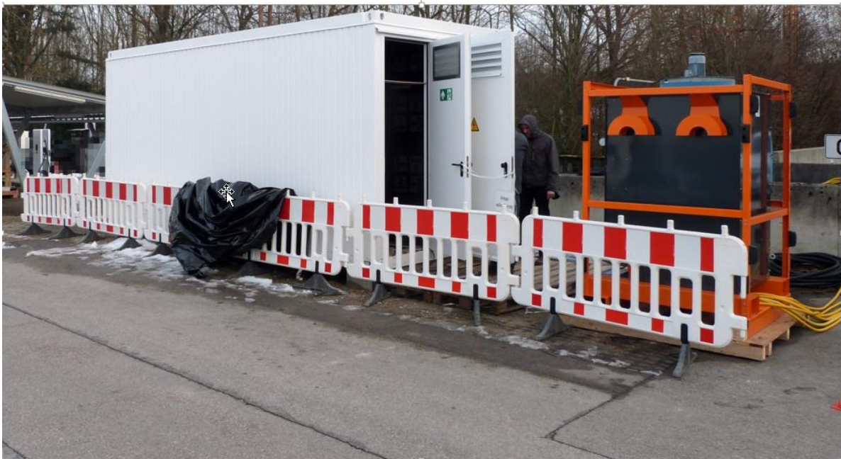
Abbildung 4 Ladetests mit Container und Leistungssenke
