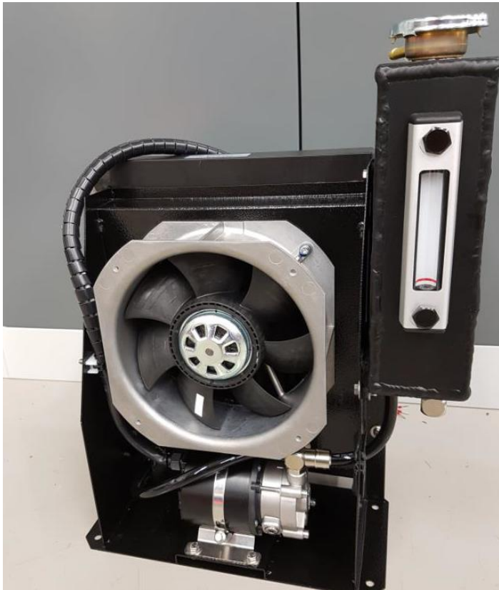
Abbildung 55 Passives Kühlgerät für HPC-Testanlagen
