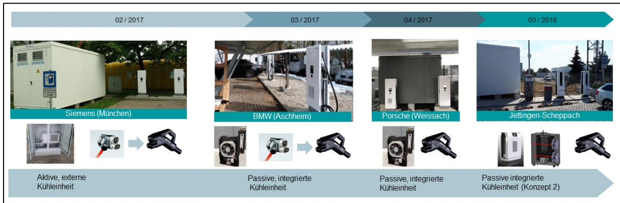
Abbildung 33 Projektspezifische Entwicklung des HPC-Ladesteckers mit Kühleinheit
