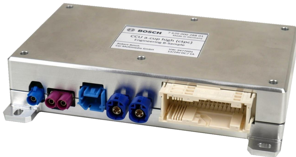
Abb. 12: RBCM CCU mit überarbeitetem Gehäuse
