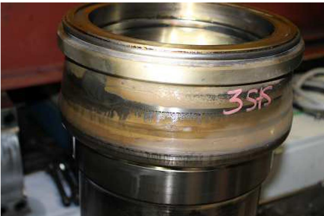
Abbildung 32: Zylinderlaufbuchse Station 3 / Kühlkragen
