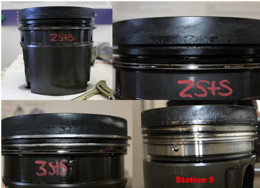
Abbildung 30: Kolben der Stationen 2, 3 & 5 (MonoteKS geschraubt, MonoteKS & ScrewteKS)
