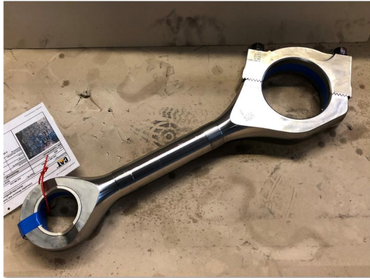
Abbildung 25: Prototypen Pleuelstange (Foto) mit verlängertem Schaft (eta-up)
