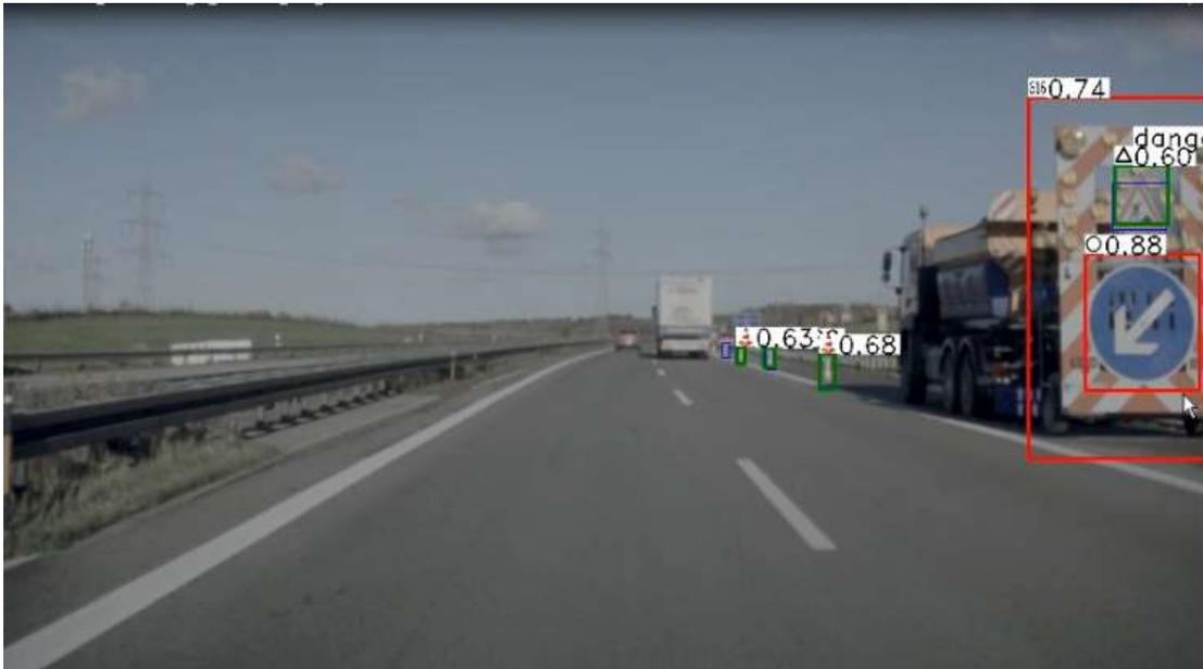
Abbildung 44: Detektion eines komplexen Hinweisschilds
