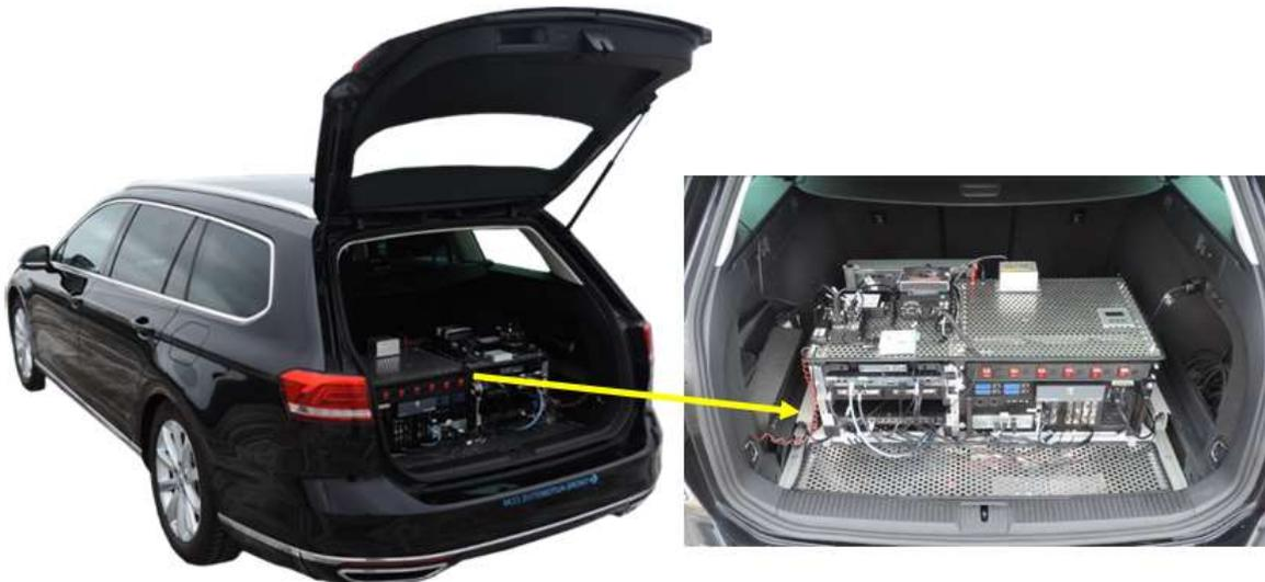
Abbildung 19: Fahrzeugaufbau VW Passat B8 Variant- Ausbaustufe 1
