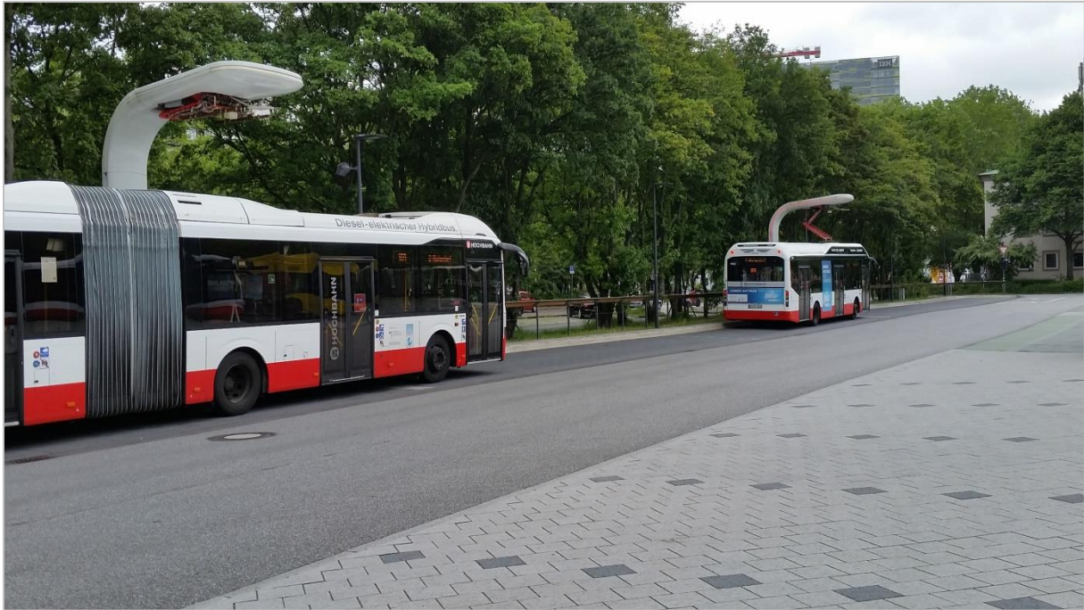
Abbildung 15: Konduktives Laden mittels Pantograph in Hamburg (Quelle: eigenes Foto)
