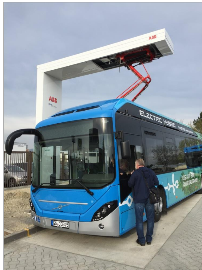
Abbildung 7: Konduktives Laden per Pantograph auf dem Betriebshof der Göttinger Verkehrsbetriebe GmbH (Quelle: eigenes Foto)
