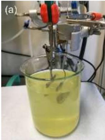
Abbildung 17: Versuchsaufbau zur elektrolytischen Abscheidung von NiFe.
