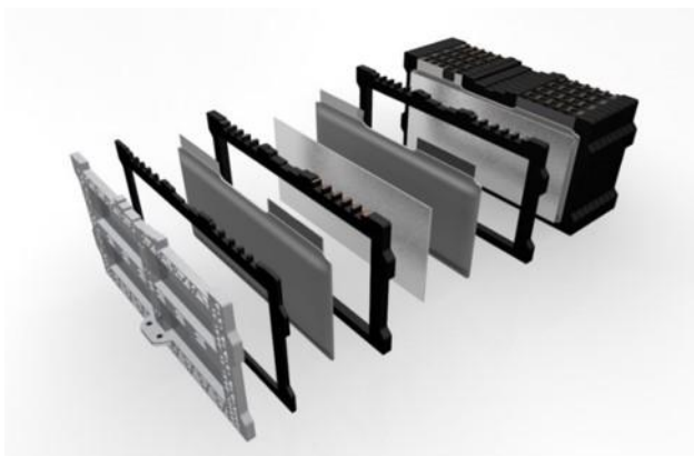
Abbildung 2: Schematischer Aufbau eines Moduls mit Brandschutzlagen
