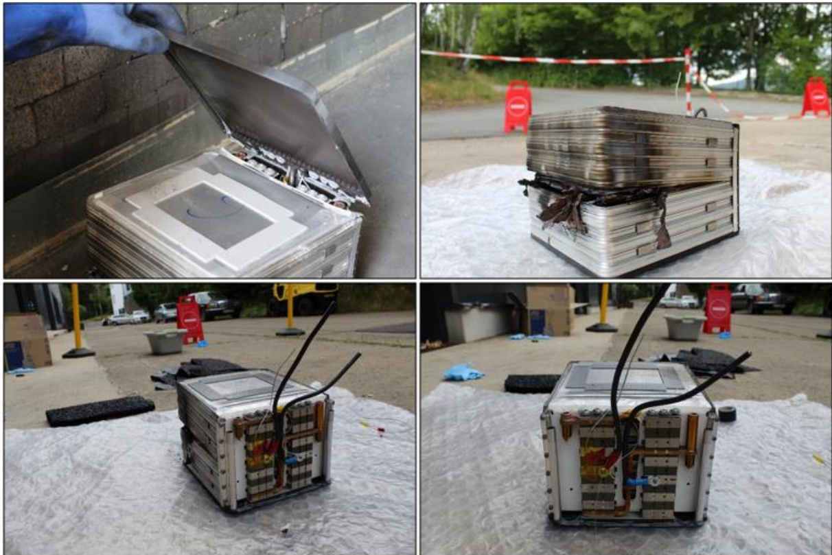
Abbildung 18: Modul mit Brandschutzlagen nach dem Versuch
