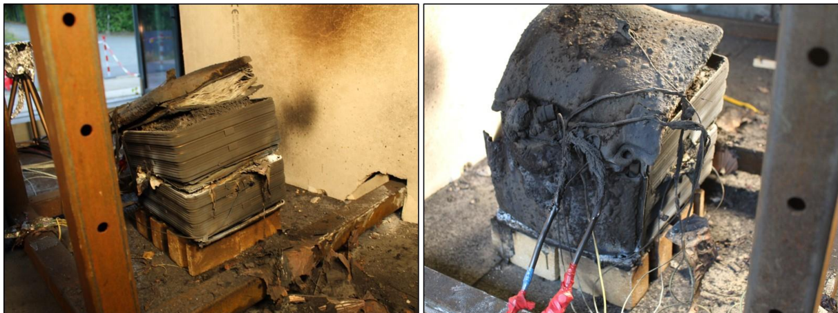
Abbildung 15: Modul ohne Brandschutzlagen nach dem Versuch im Brandofen
