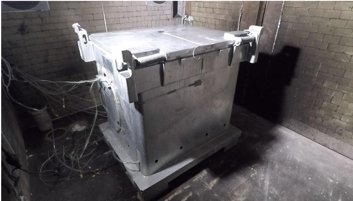
Abbildung 5: Havariebehälter zur Gasentnahme im Brandofen des BSTZ
