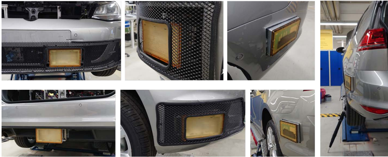
Abbildung 81: Verbau der 6 Bosch DEM#2a Radare in einen Golf7 Variant
