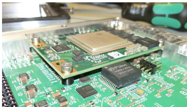
Abbildung 18: Montiertes Zync MPSoC Modul auf der Basisbandplatine
