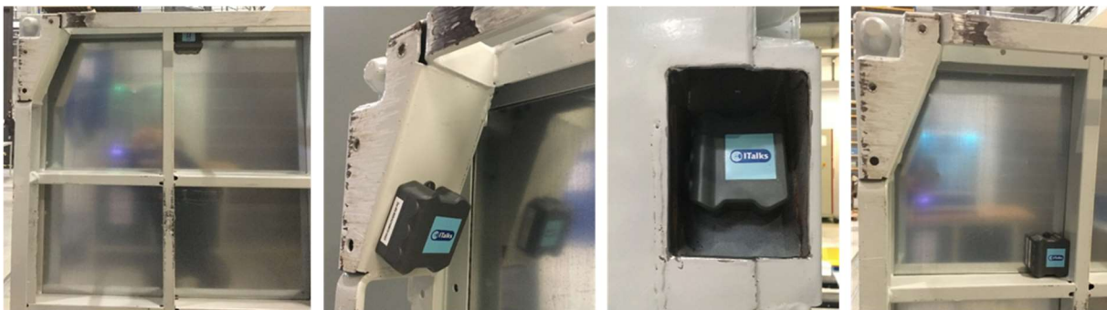
Abbildung 9-5: Anbringungspositionen des IoT-Device von links nach rechts: U-Profil (Rand), hinter dem Behälterfuß, integriert im Behälterfuß, Unterboden (mittig)
