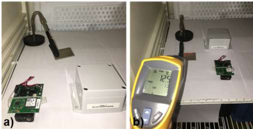
Abbildung 9-6: Temperaturmessung: a) IoT-Devices mit und ohne Gehäuse, b) Referenzmessung mit optischem Infrarotthermometer
