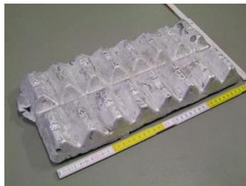
Figure 7.13 AlCa10-Massel von KBM AFFILIPS als Vorlieferung für AlMgCaSc Pulverfertigung
