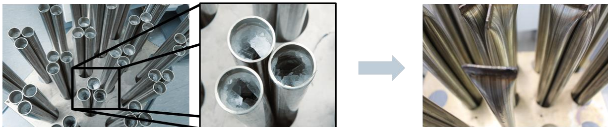
Abbildung 120: Kapselgeometrie mit 25 und 40 mm Außendurchmesser und Darstellung des Befüllprozesses
