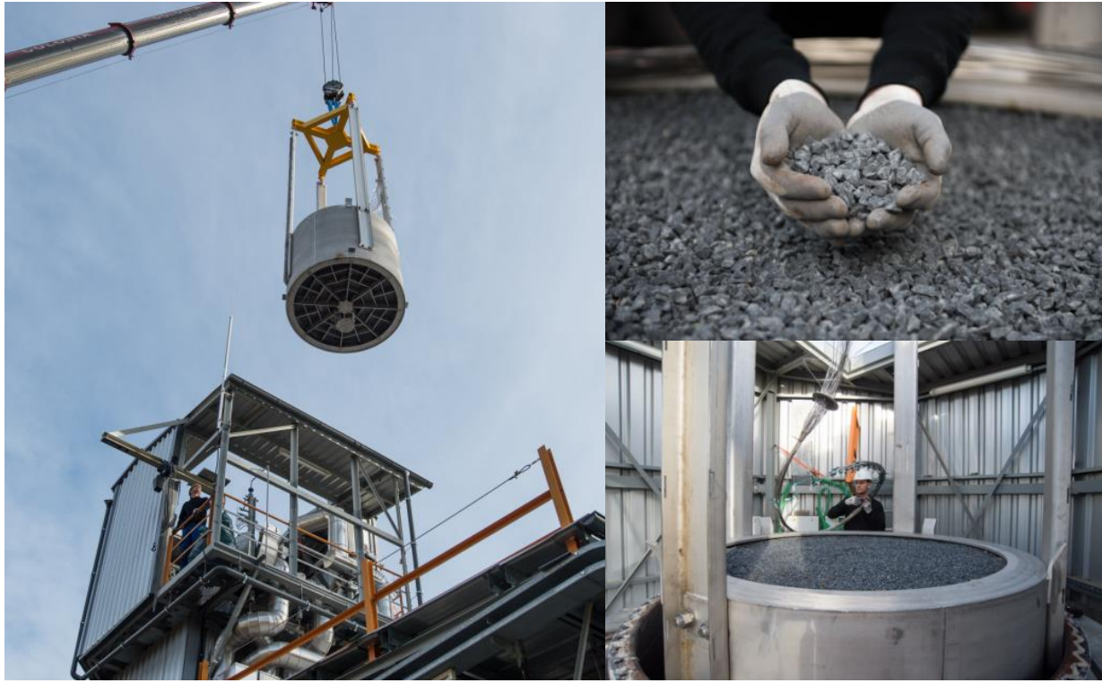
Abbildung 107: Vorbereitung des Thermocline-Filler-Versuchs – Technikumsanlage TESIS: Einheben eines Versuchskorbes gefüllt mit Basaltgestein (links), Basaltsteinschüttung in den Versuchskorben (rechts oben), Positionierung des Versuchskorbes während des Einhebens in den Versuchsbehälter (rechts unten)
