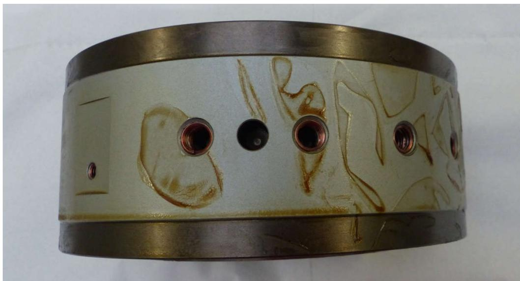
Abbildung 6-19: Für LIBRAS-2 modifiziertes Fine-Cyclo-Getriebe mit Schnittstelle zur Montage des Abtriebhebels (Getriebe mit Spuren vom Konservierungsmittel zum Schutz der Oberflächen)
