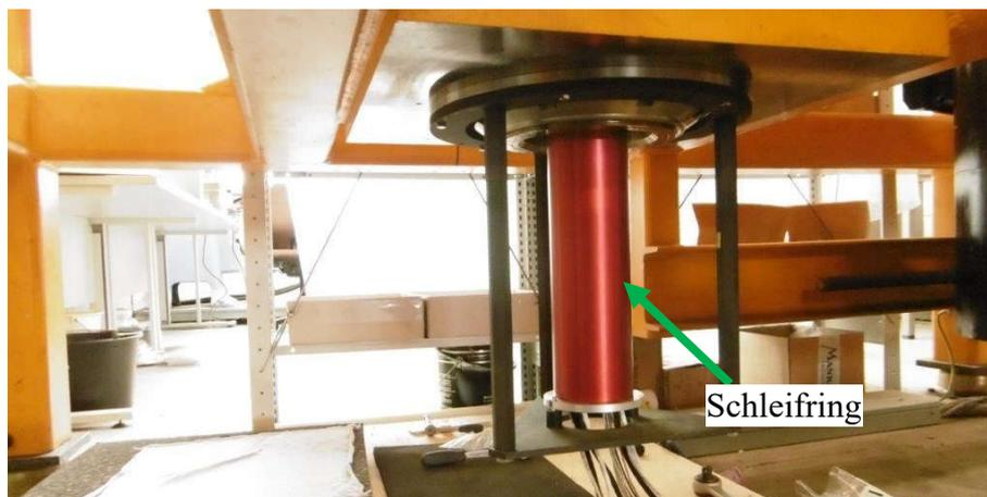
Abbildung 6-123: Integration des Schleifrings am Systemprüfstand
