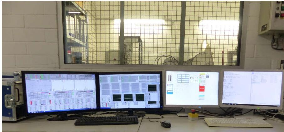
Abbildung 6-127: Versuchssteuerung - Ansteuerung und Monitoring der APCU mit dem TCC inkl. FCC Emulator (links) und dSPACE-System zur Freigabe und Steuerung der Energieversorgung über das E-Rack (rechts)
