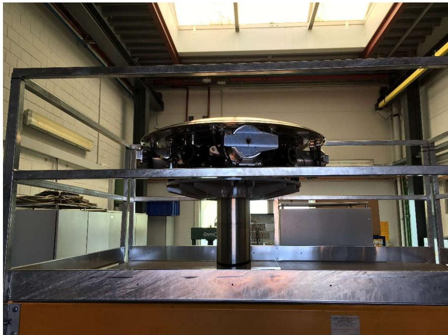
Abbildung 6-130: Systemprüfstand mit eingerüstetem LIBRAS<sup>®</sup>-System
