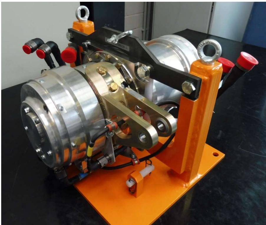
Abbildung 6-43: Vollständig montiertes EMA Erprobungsmuster
