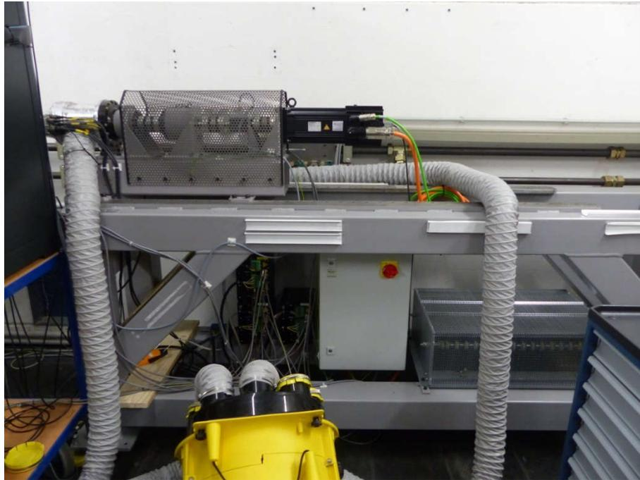
Abbildung 6-36: Aufbau Performance Test - Qualifikationsmuster E-Maschine mit externer Zusatzkühlung am Motorprüfstand
