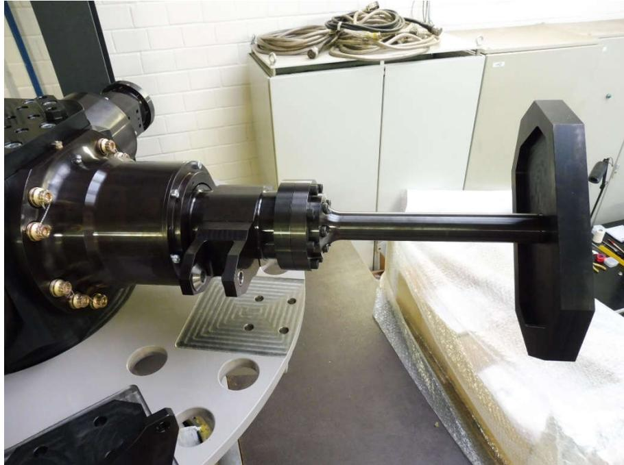
Abbildung 6-124: Zusammenbau des Rotorblattsimulators am Systemprüfstand
