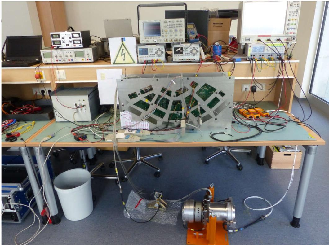
Abbildung 6-96: Integrationstest aller Systemkomponenten – Versuchsaufbau mit allen Systemkomponenten, externer Energieversorgung und Rotorazimut-Emulator
