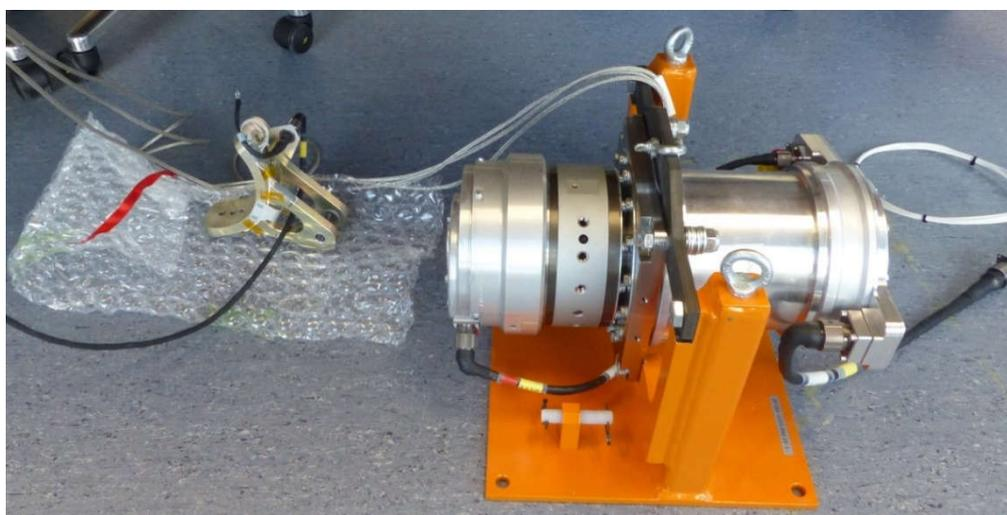
Abbildung 6-98: Integrationstest aller Systemkomponenten – EMA Erprobungsmuster, bei dem aus Sicherheitsgründen der Abtriebshebel demontiert wurde
