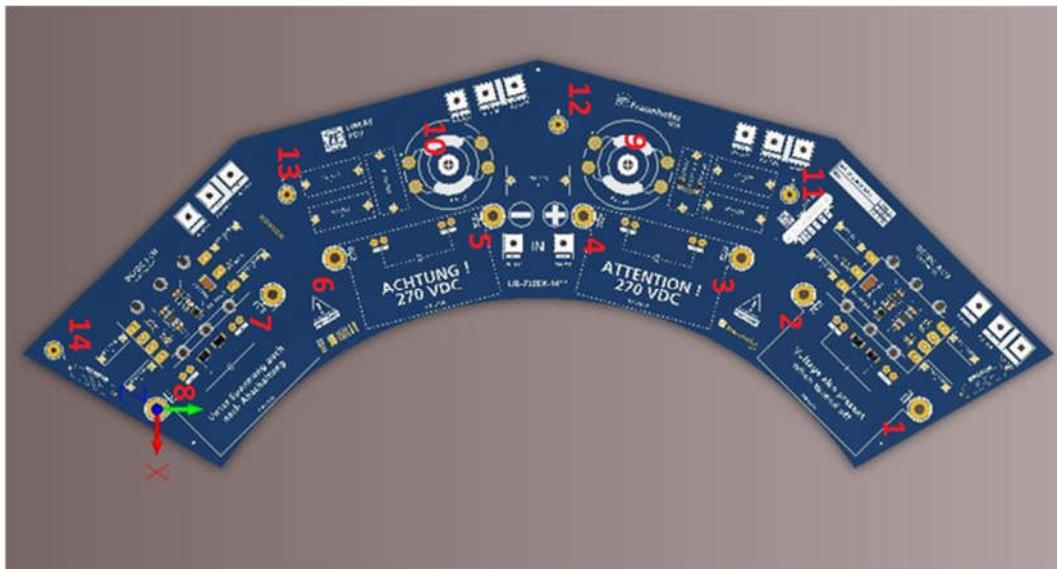
Abbildung 6-52: CAD-Modell der bestückten PSU (die Ziffern bezeichnen die Befestigungspunkte für die Fixierung am Gehäuse der APCU)
