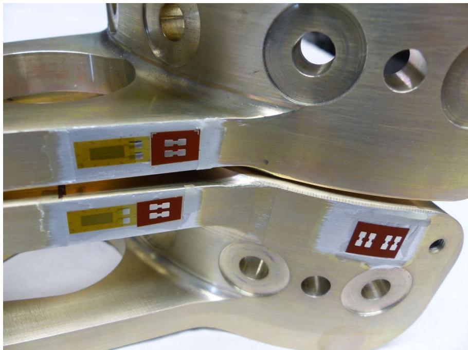
Abbildung 6-21: Instrumentierung am Hebel des EMA mit DMS-Messstellen
