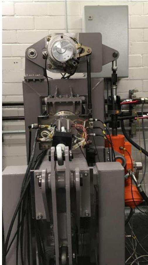
Abbildung 6-35: Fatigue- und Funktionsprüfstand nach Abschluss der Aufbauphase und Einrüstung der beiden EMAs
