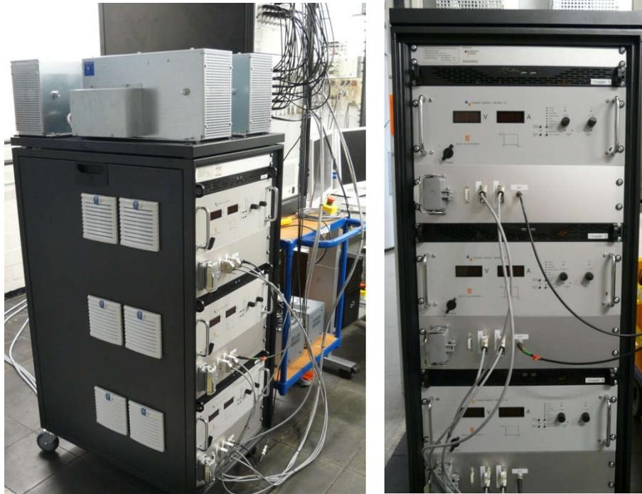
Abbildung 6-31: Energieversorgung (inkl. Bremswiderstände und Chopper-Elektronik) zur Verwendung an Fatigue- und Systemprüfstand, angesteuert und kontrolliert durch dSPACE System
