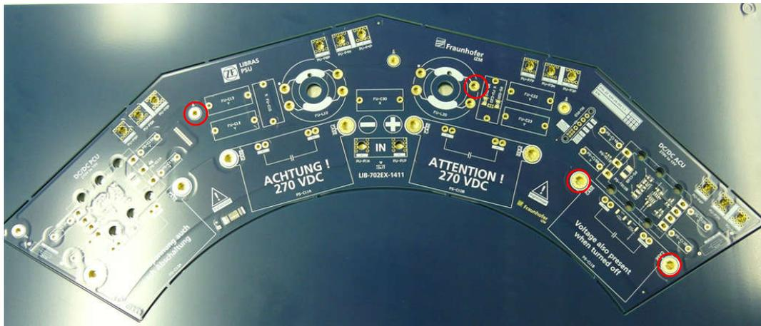
Abbildung 6-57: Unbestückte PSU-Platine (Fertigungslos 2)
