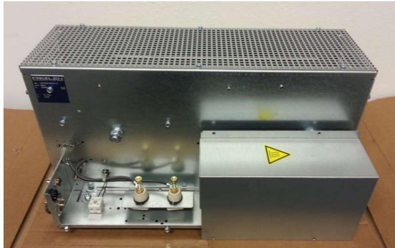
Abbildung 6-30: Komponente für die *Brems-Chopper* Widerstände
