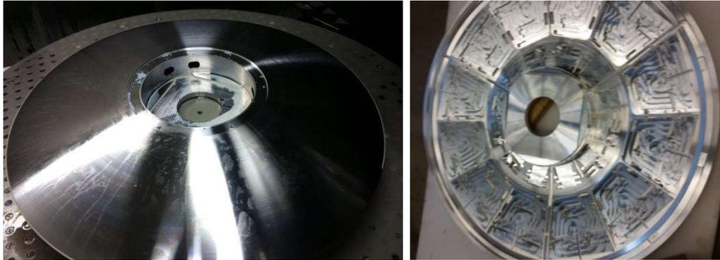
Abbildung 6-63: Bild aus der Fertigung des APCU-Gehäuse-Grundkörpers (Außen und Innen)
