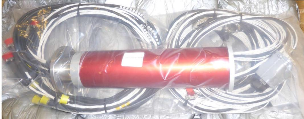
Abbildung 6-122: Schleifring X99-0029-970-006 für den Einbau in den Systemprüfstand X99-0029.970 bei Anlieferung
