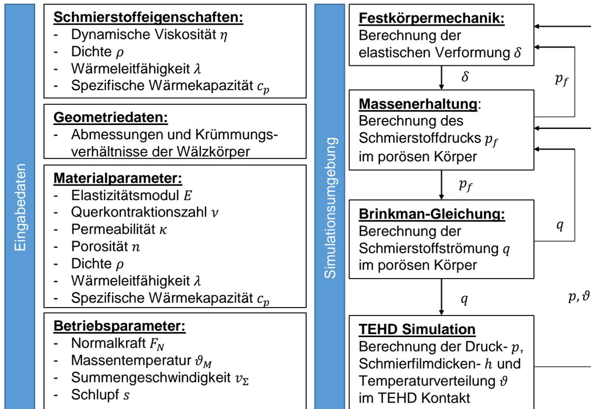
**Bild 60:** Eingabedaten und Aufbau des gekoppelten Simulationsmodells zur Berechnung der Schmierstoffströmung im porösen Sintermaterial und im TEHD-Kontakt.
