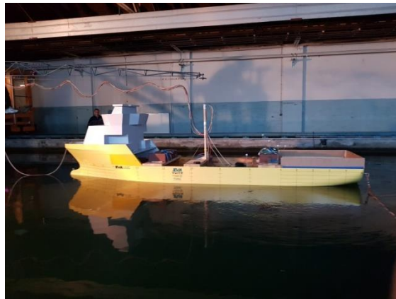
Abbildung 5: Modell der Edda Fram während der DP-Versuche im April 2018
