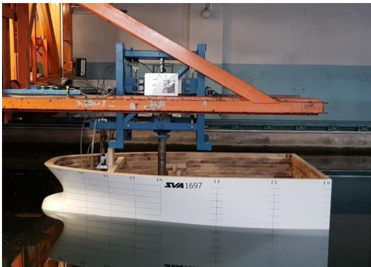
Abbildung 23: Messaufbau für Querkraftmessungen
