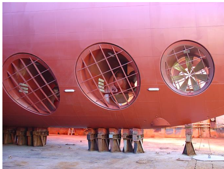
Abbildung 15: Beispiel für Bugstrahler am Schiff (Quelle: http://www.brunvoll.no )
