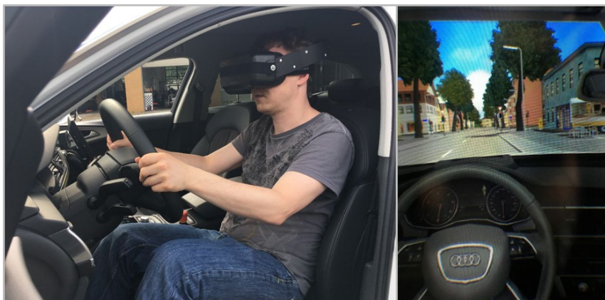
Abbildung 60: Links: Ein Proband mit aufgesetzter VR-Brille. Rechts: Beispielhafte Sicht des Probanden durch die VR-Brille während einer Fahrt in der simulierten Umgebung (Foto: Institut für Regelungstechnik).
