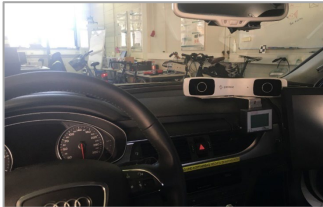
Abbildung 61: Headtracking System auf dem Armaturenbrett (weiß), welches die Kopfposition und Kopfbewegung des Probanden detektiert, sodass diese bei der Bildgenerierung in der Simulation berücksichtigt werden kann (Foto: Vanessa Stange).
