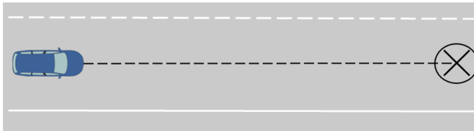
Abbildung 12: Errechnete Zielpose und Referenzpfad aus der Verhaltensentscheidung mit dem berechneten Manöver „Fahrstreifen folgen“
