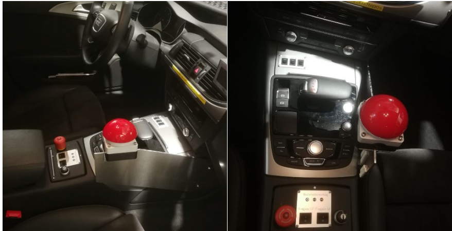
Abbildung 62: Im Cockpit verbauter Knopf, der für die Auslösung des Haltevorgangs aus Fahrszenario „Einmündung“ genutzt wurde (Fotos: Susanne Ernst)
