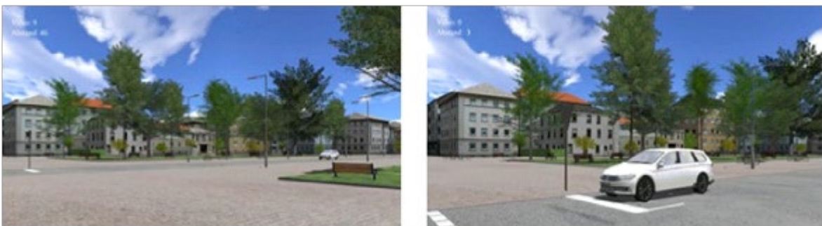
Abbildung 10: Einmündung aus der Außensicht eines schwächeren Verkehrsteilnehmers. Links: Heranfahrt an die Einmündung. Rechts: Das automatisierte Fahrzeug hält an der Haltelinie, um dem schwächeren Verkehrsteilnehmer Vorfahrt zu gewähren.
