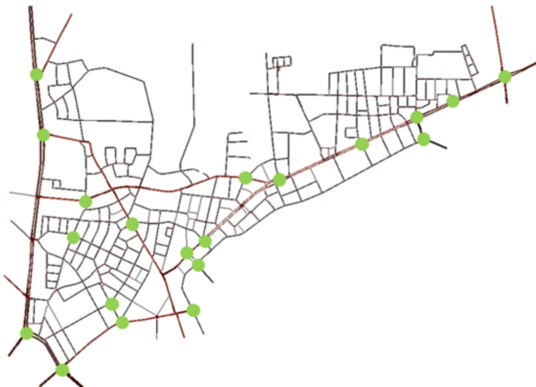
Abbildung 90: Hannover-List SUMO-Netzwerk. Die grünen Markierungen kennzeichnen die Knotenpunkte mit zur Verfügung stehenden Detektorzählungen.
