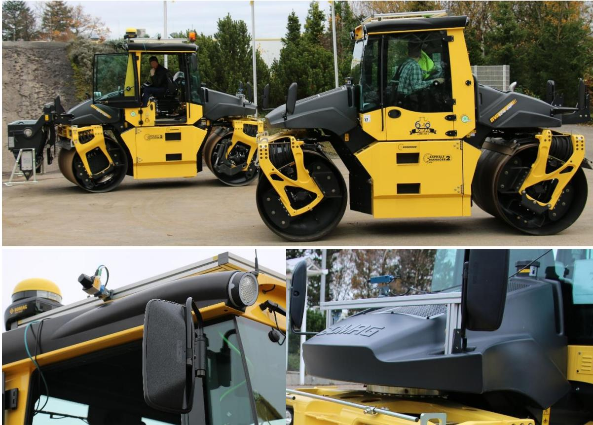
Abbildung 10: Sensorik Odometrie (Oben), Laserscanner (Unten links) Stereokamera (Unten rechts)
