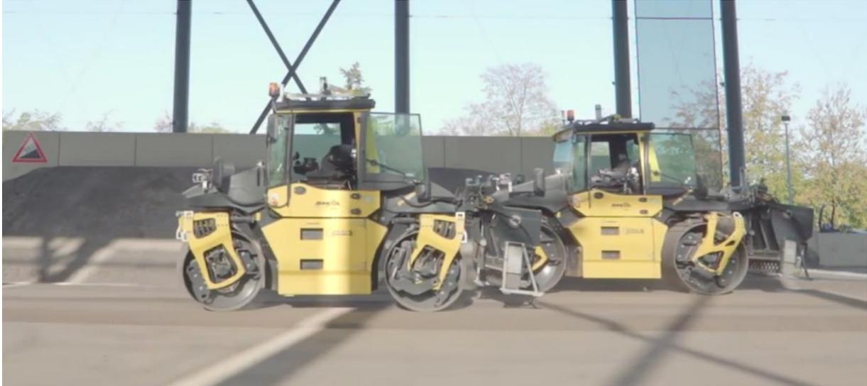
Abbildung 15: Abschlussdemo Scenario 2 "Autonome Hauptverdichtung"
