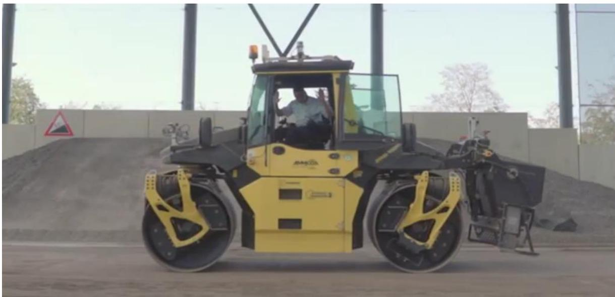
Abbildung 14: Abschlussdemo Szenario 1 "Autonome Rückwärtsfahrt"
