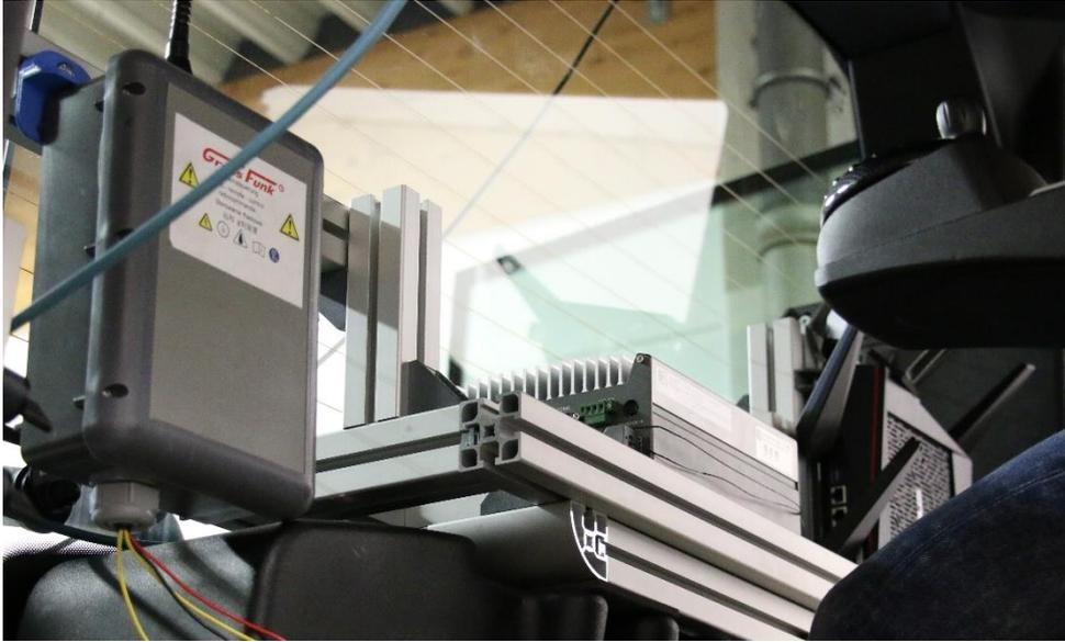
Abbildung 11: Montage Hardware (Fernsteuerungseinheit)
