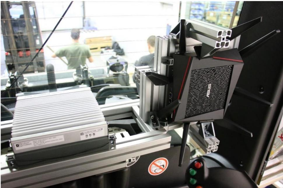
Abbildung 12: Montage Hardware (Recheneinheiten und Netzwerklösung)
