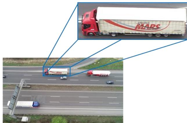
**Abbildung 2: Perspektivische Bildflug aus ca. 50 m Höhe und Fahrzeugdetails bei nachträglichem Zoom (5.472 x 3.078 Pixel) [Sky-High-Views GbR, 2018]**
