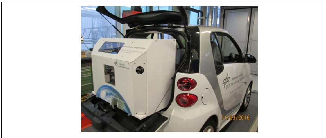
Abbildung 15: DLR-Versuchsfahrzeug eSmart mit HT-PEM-Brennstoffzellen-Range-Extender
