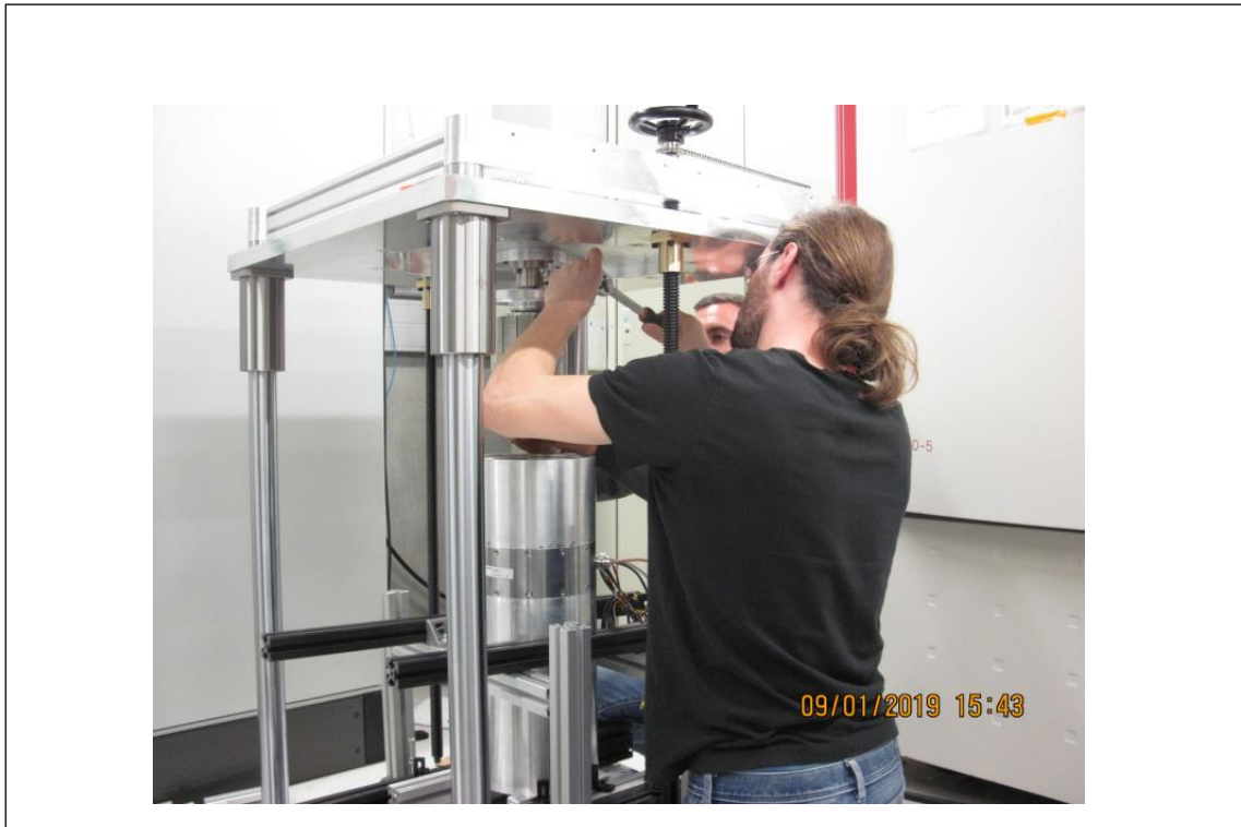
Abbildung 92: Montagegestell für die Montage der Rotoren in die Statorgehäuse
