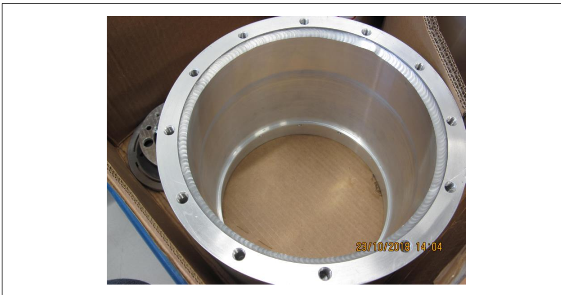
Abbildung 82: Aus zwei Einzelteilen zusammenschweißtes Gehäuse des kleineren Motors M2
