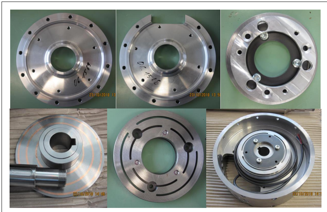
Abbildung 83: Lagerschilde und Kupplungsanbauteile
