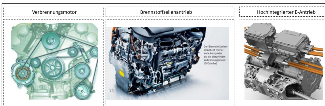
Abbildung 37: Riementrieb für die Hilfsaggregate am Verbrennungsmotor (links); Modulares Brennstoffzellensystem (mitte); Antriebseinheit aus zwei Elektromotoren mit Leistungselektronik (rechts)
