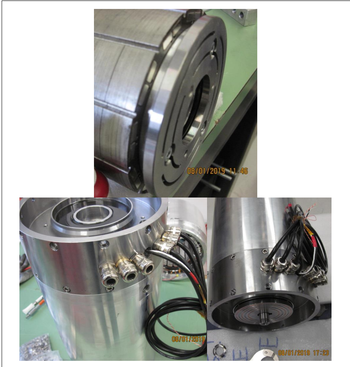
Abbildung 91: Kupplung zwischen Fahrmotor (Motor 1) und Kompressormotor (Motor 2), Rotorseite Motor 2 links oben
