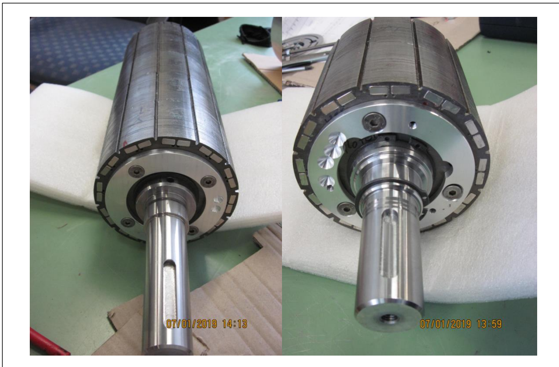
Abbildung 86: Mit Magneten bestückte Rotoren (Motor 1 links, Motor 2 rechts)
