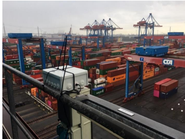
Abbildung 6-25: RTK Box(links) für Kranpositionbestimmung, RTK Box auf dem Kran(rechts)
