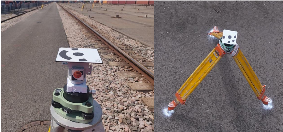
Abbildung 6-48. Der Aufbau des Markers mit den Prismen: linke Seitenansicht: die Zentren des Prismas und des Markers sind kollinear angeordnet; die Abstände sind bekannt. Rechts: Marker in der Luftaufnahme
