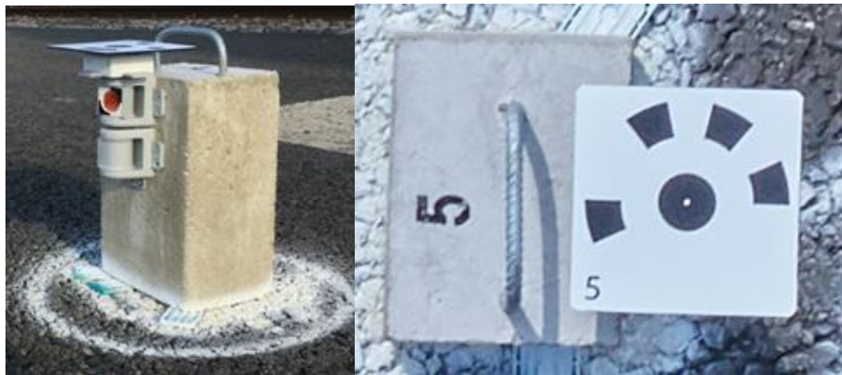
Abbildung 6-47 Der Aufbau des Markers mit den Prismen: linke Seitenansicht: die Zentren der drei Elemente sind kollinear angeordnet, die Abstände sind bekannt. Rechts: Marker in der Luftaufnahme.
