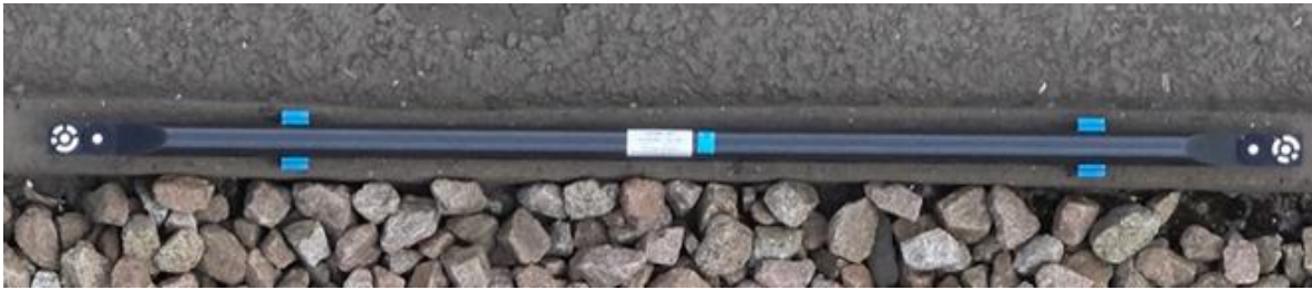
Abbildung 6-64. Kalibrierter CFK-Maßstab zur Überprüfung des lokalen Abbildungsmaßstabs
