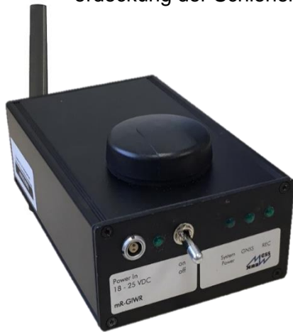
Abbildung 6-25: RTK Box(links) für Kranpositionbestimmung, RTK Box auf dem Kran(rechts)
