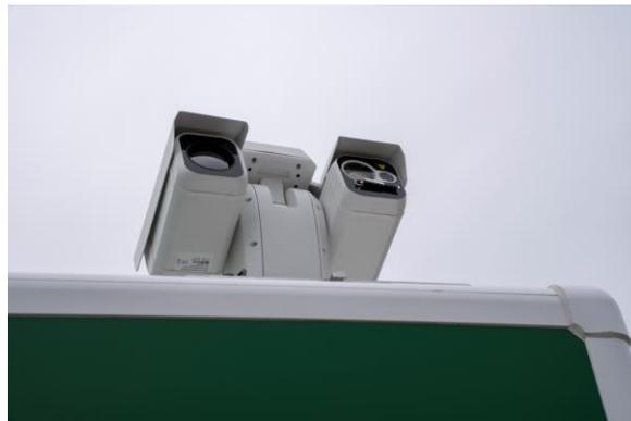
Abbildung 5: Verifikationskameras (optisch und thermal)
