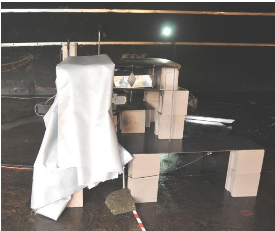
Abbildung 47: Vorbereitung der Brandbegrenzungsdecke
