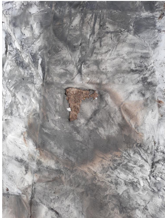
Abbildung 58: Durchglüh-Stellen an der Decke (Nach Einschalten des Sprinklers und nach kompletter Abdeckung), Loch an dieser Stelle nach späterer Explosion
