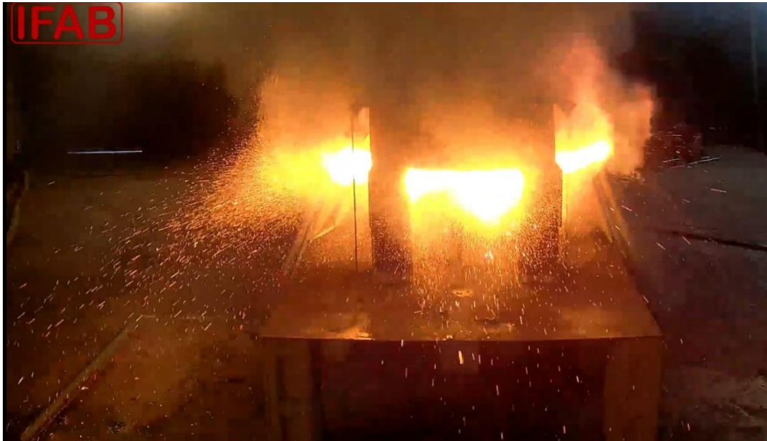
Abbildung 55: Durchzündung von Zellen, Wegfliegen von Teilchen, vor Auflegen der Brandbegrenzungsdecke
