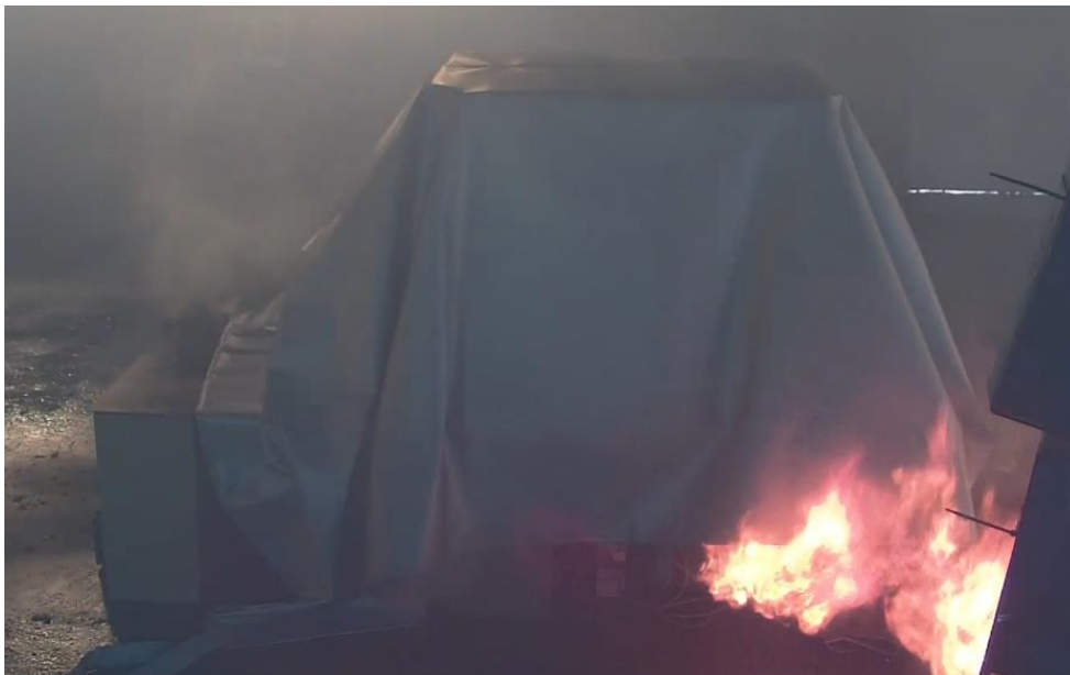
Abbildung 53: Entweichen von Rauchgasen mit Durchzündung
