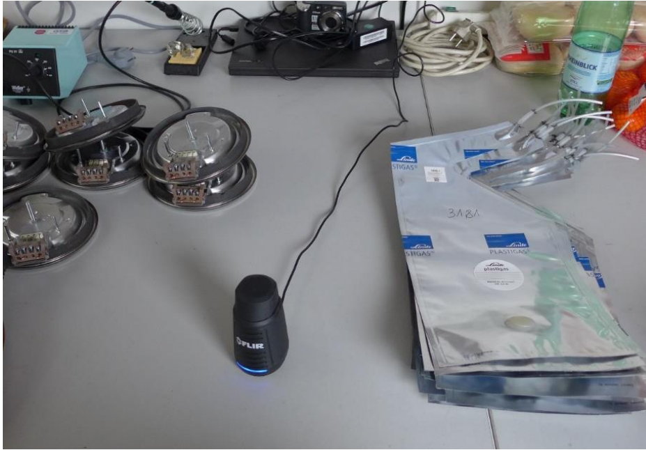
Abbildung 43: Rechts- Gasprobenbeutel mit Sauganschluss, nach Befüllen kann der Beutel durch Umknicken des oberen „Zipfels“ dicht verschlossen werden, links- verwendete Heizplatten
