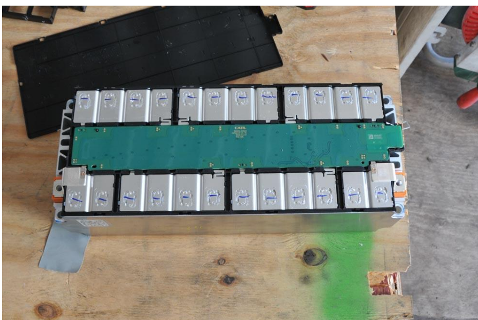
Abbildung 39: Batteriemodul, bestehend aus 12 prismatischen Li-Ionen-Zellen
