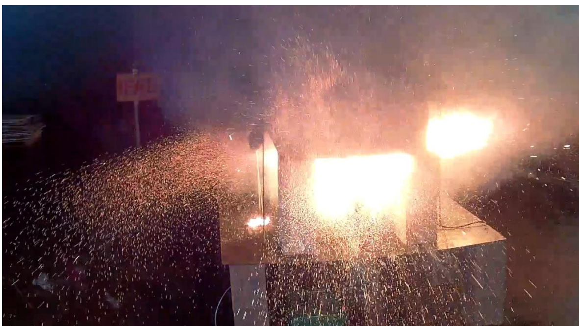
Abbildung 49: Wegsprühen von Teilchen während der Zellexplosionen
