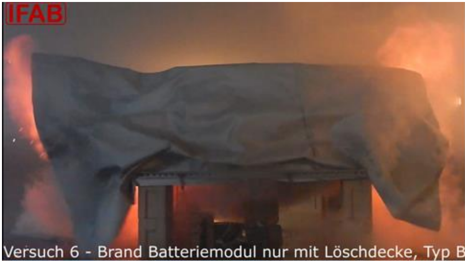
Abbildung 56: Durchzündn entweichender Gase, dabei Aufliegen der Decke
