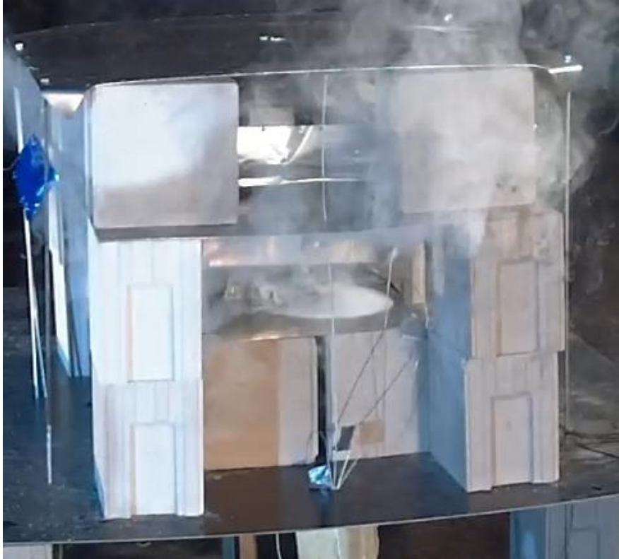
Abbildung 48: „Dampflache“ nach Aufplatzen der ersten Zellen
