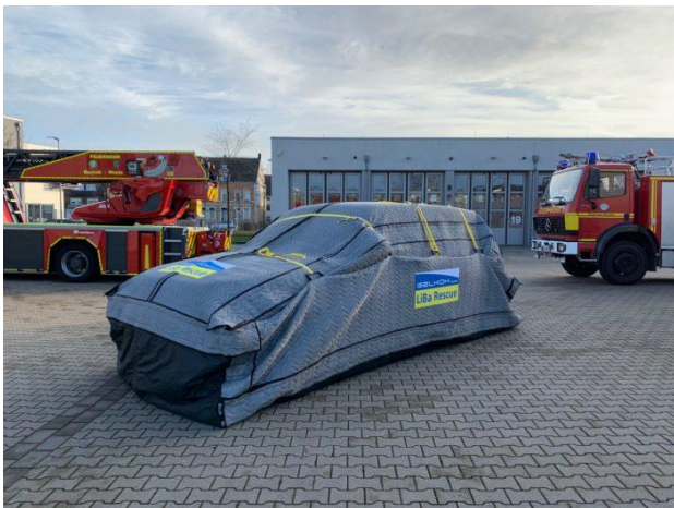
Abbildung 37: Einhüllung für havarierte Elektrofahrzeuge
