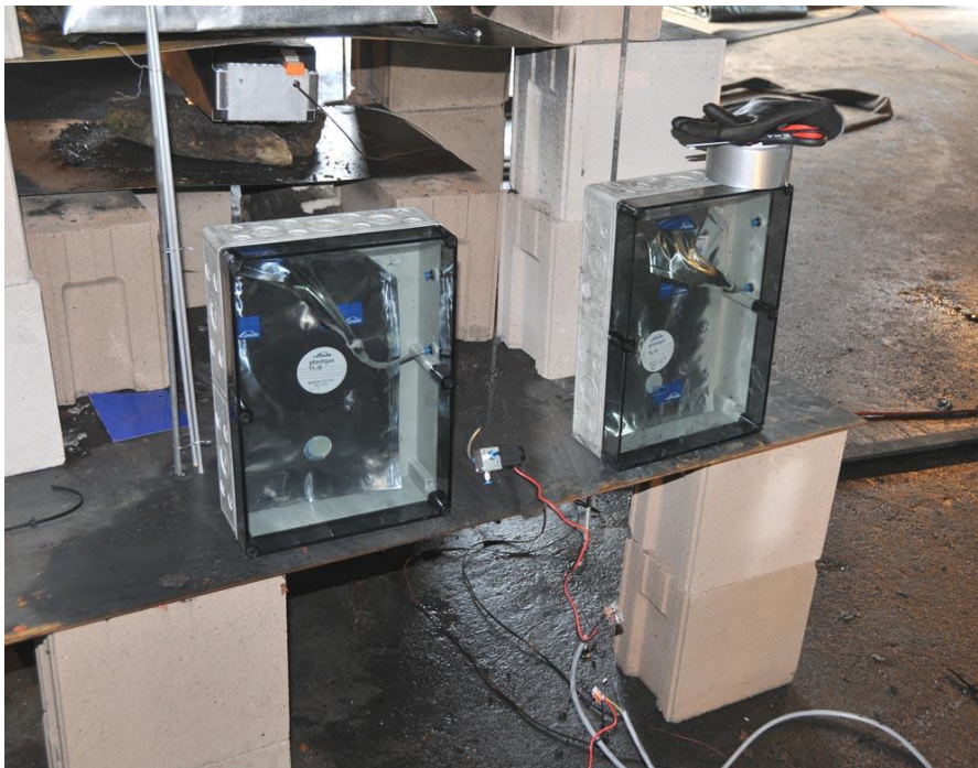
Abbildung 44: Gasprobenbeutel im Kunststoffgehäuse, Bildmitte: Mini-Membranpumpe
