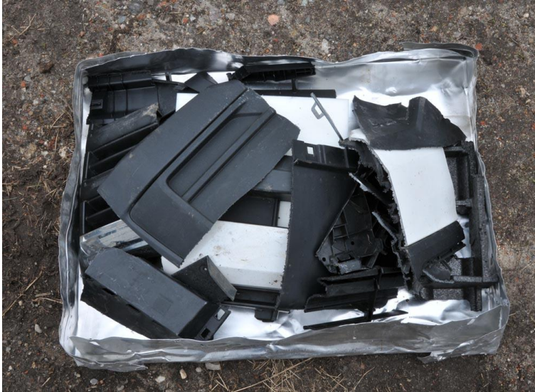
Abbildung 40: Aluminiumwanne mit Kunststoff-Materialmix
