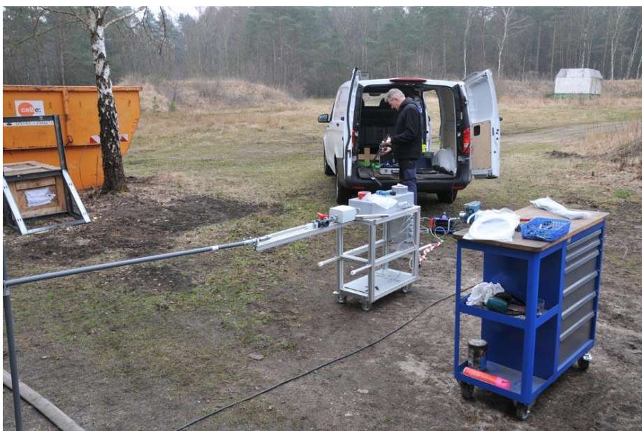
Abbildung 46: Absaugung für die Wasserstoffmessung, Messaufbau
