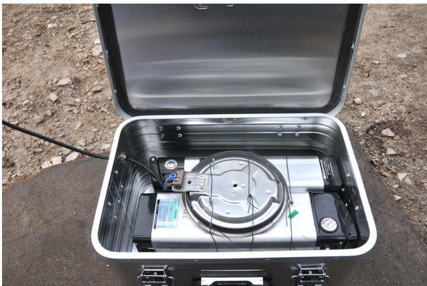
Abbildung 4: Versuchsaufbau, Versuchsreihe B: Fahrradakkus in Alukiste mit Heizplatte
