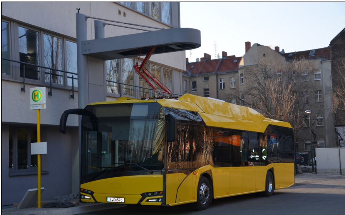
Abbildung 10: E-Bus mit prototypischer Ladestation auf dem EUREF-Campus.
