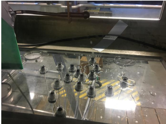
**Abb. 5.2:** Hydrofonarray in der unteren Scheibe der kleinen Messstrecke; Bündige Hydrofonmontage
