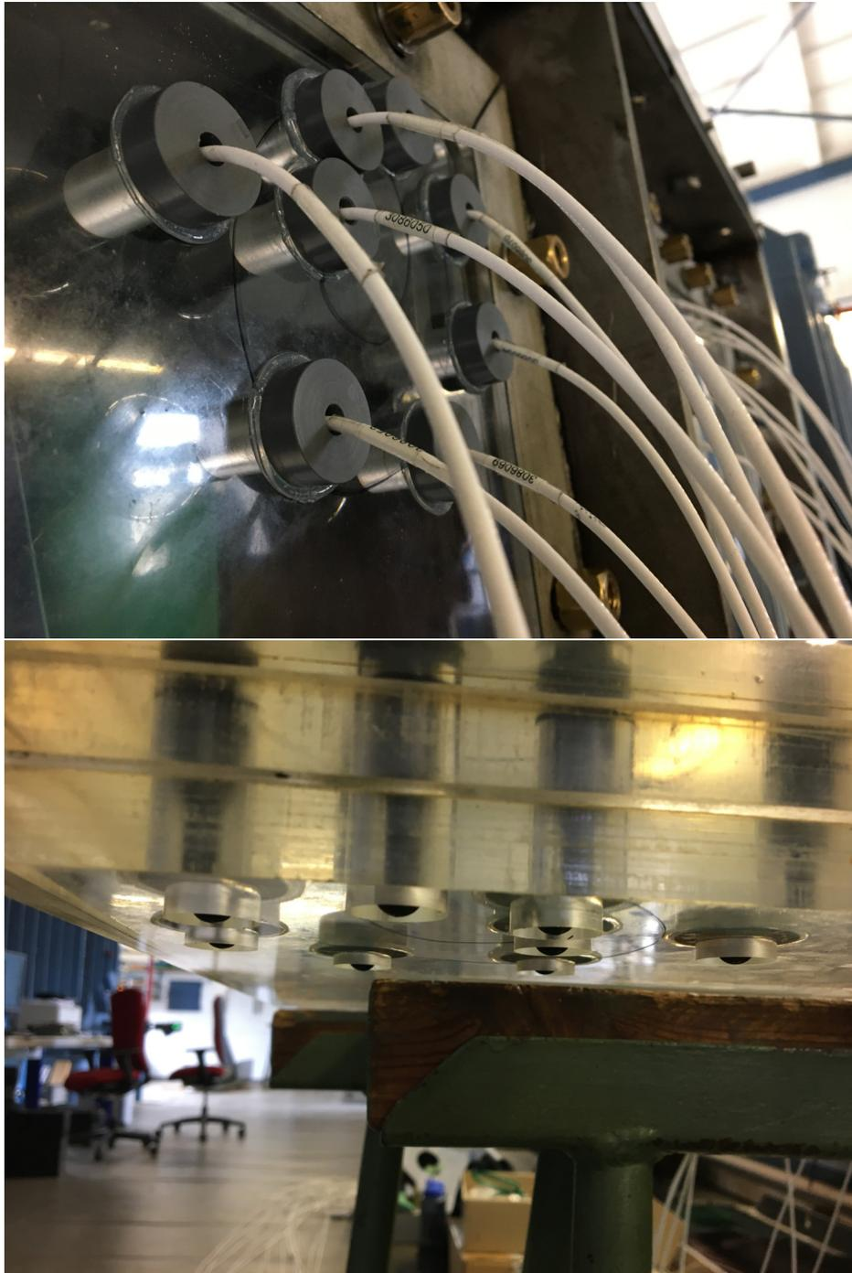
**Abb. 6.3:** Hydrofonhalterungen in der Scheibe (oben); Sitz der Hydrofone in der Scheibe (unten)
