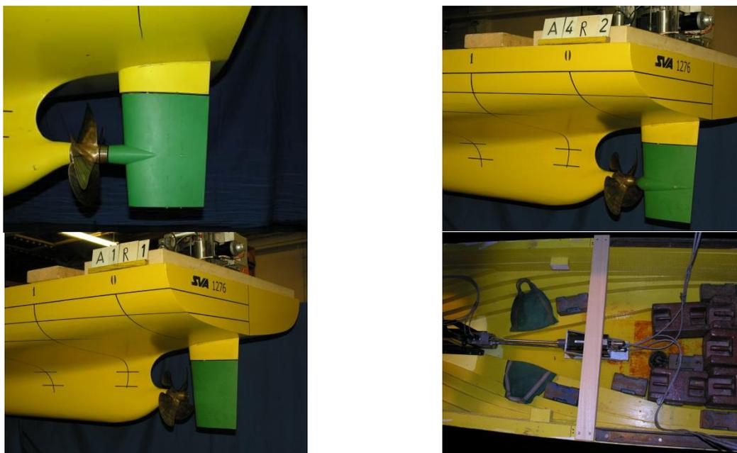
**Abbildung 4: Messkonzepte zur Messung von ESD-Kräften. Oben Propulsionsbirnen, unten Nabenkappenflossen**
