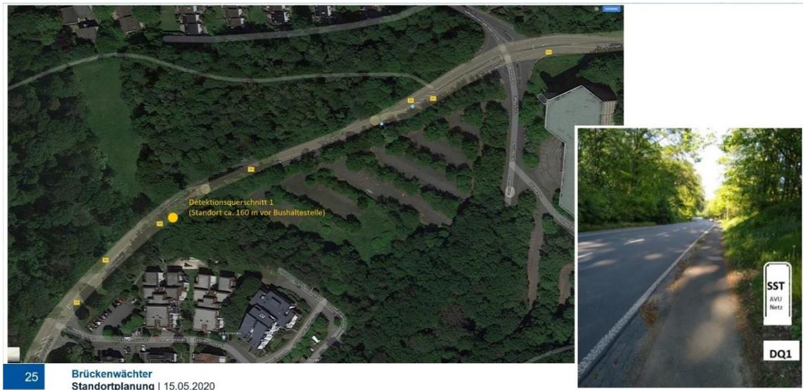
**Abbildung 37:** MQ 1 mit projektspezifischer Energieversorgung über eine Hausanschlußsäule
