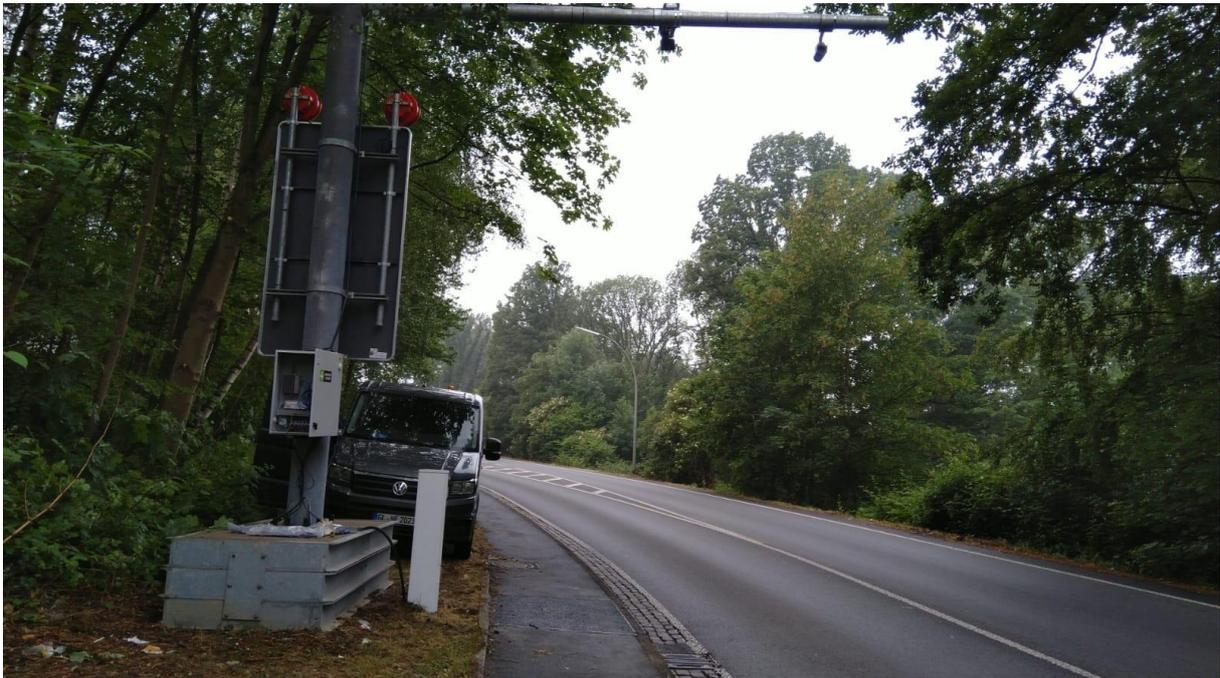
**Abbildung 17:** MQ 1 mit fahrbahnmittiger Montage des Laserscanners und Videodetektor auf einem Peitschenmastausleger der mobilen Aufstellvorrichtung (Rückseite)
