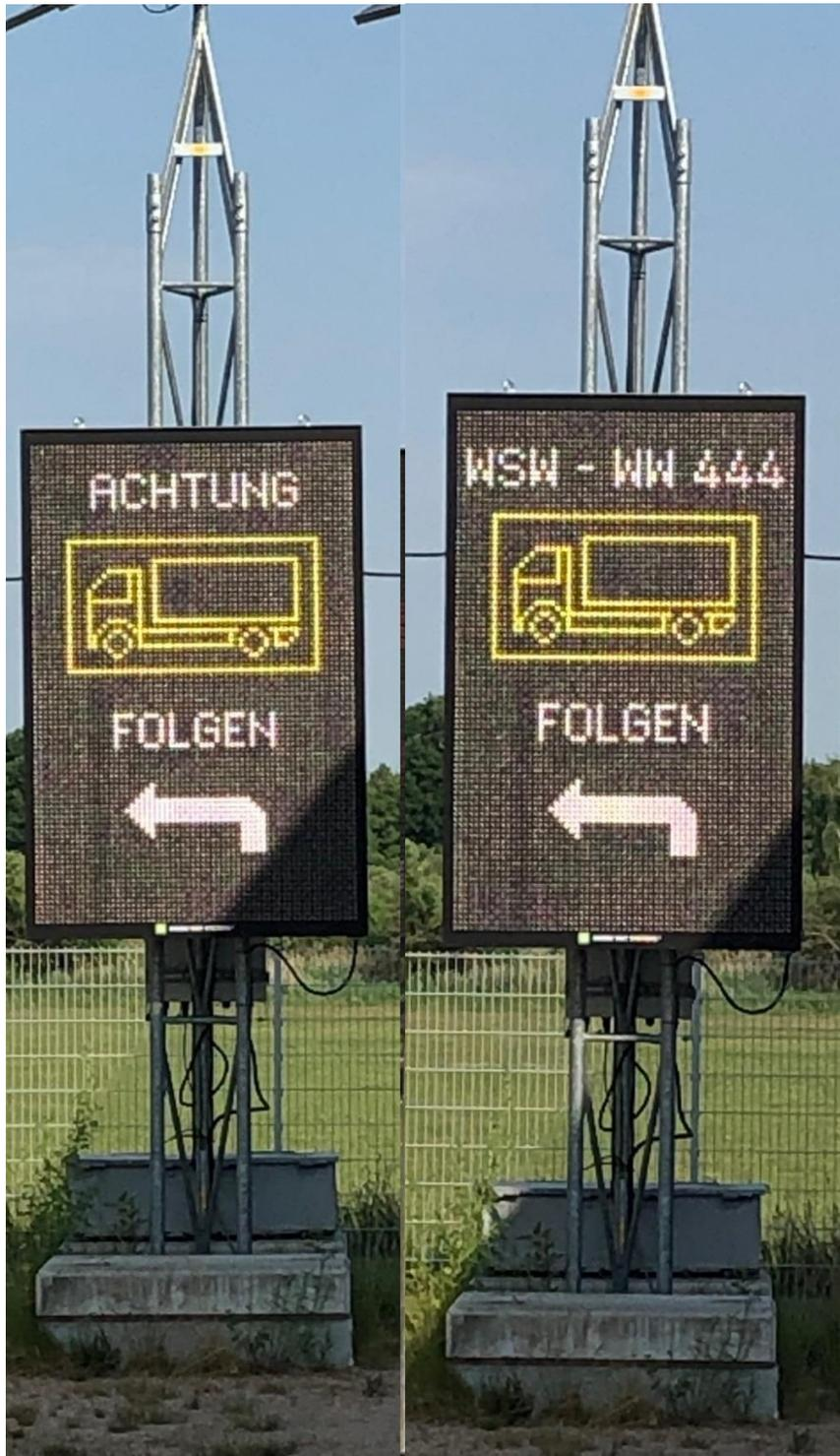
**Abbildung 22:** dynamische Wechselverkehrszeichen (mit frei programmierbaren Anzeigeflächen)
