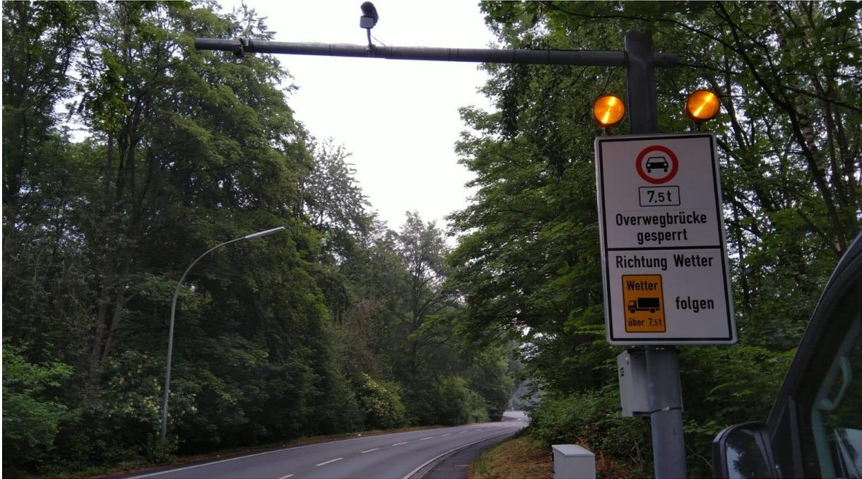
**Abbildung 16:** MQ 1 mit fahrbahnmittiger Montage des Laserscanners und Videodetektor auf einem Peitschenmastausleger der mobilen Aufstellvorrichtung
