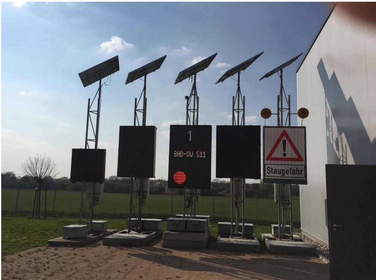
**Abbildung 32:** Muster von mobilen Aufstellvorrichtungen mit dynamischen Anzeigeelementen inkl. Photovoltaik-Anlage und Pufferbatterien auf dem mobilen Fundament
