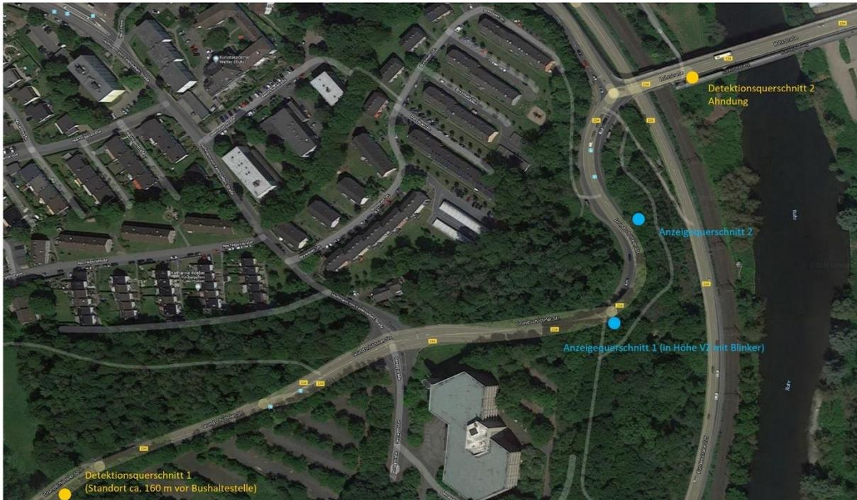
Abbildung 12: Detektions- und Anzeigestandorte der dynamischen Verkehrszeichen
