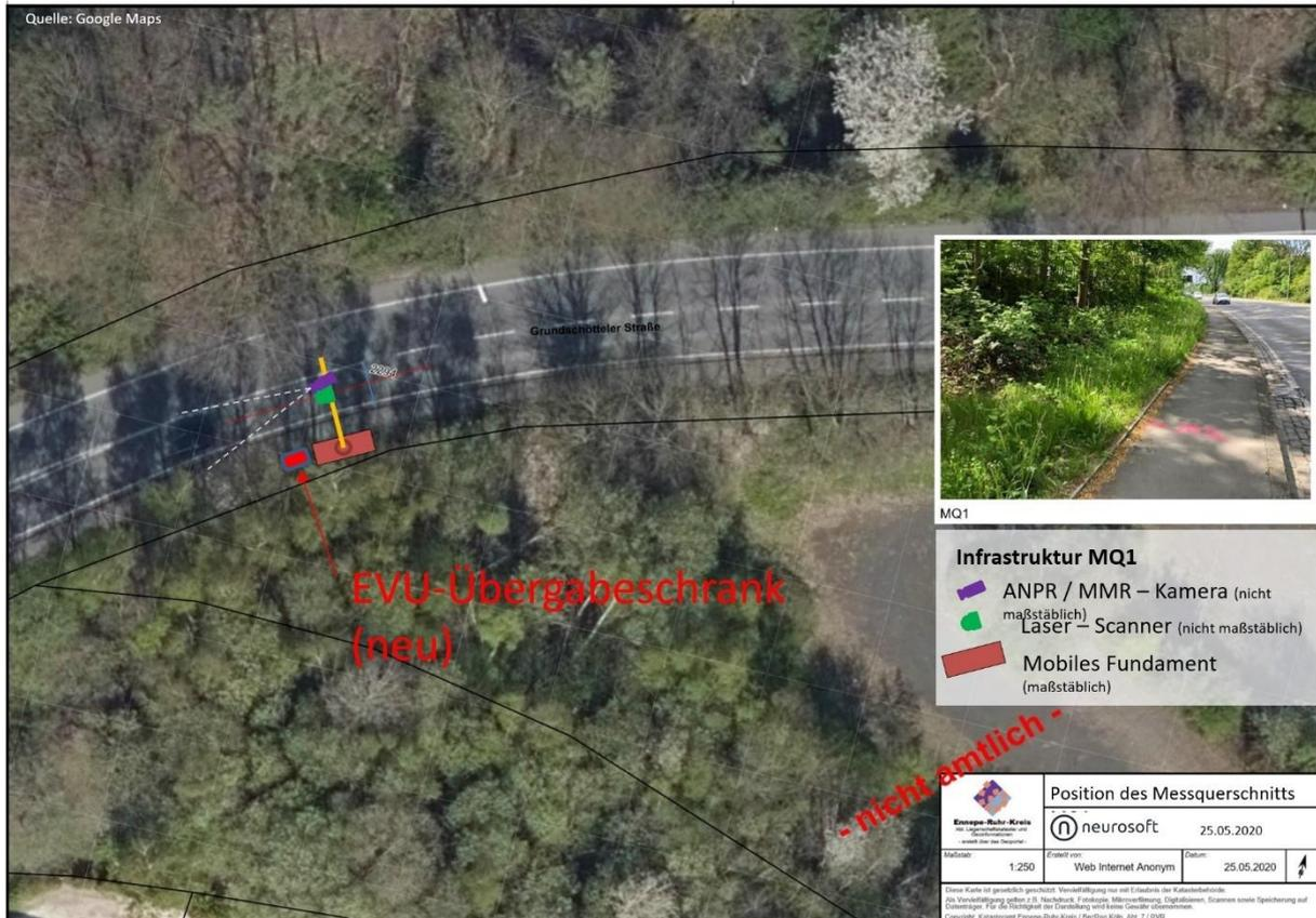
Abbildung 15: Prinzipabbildung von MQ 1 mit mittlerer Montage der Detektoren auf einem Peitschenmast
