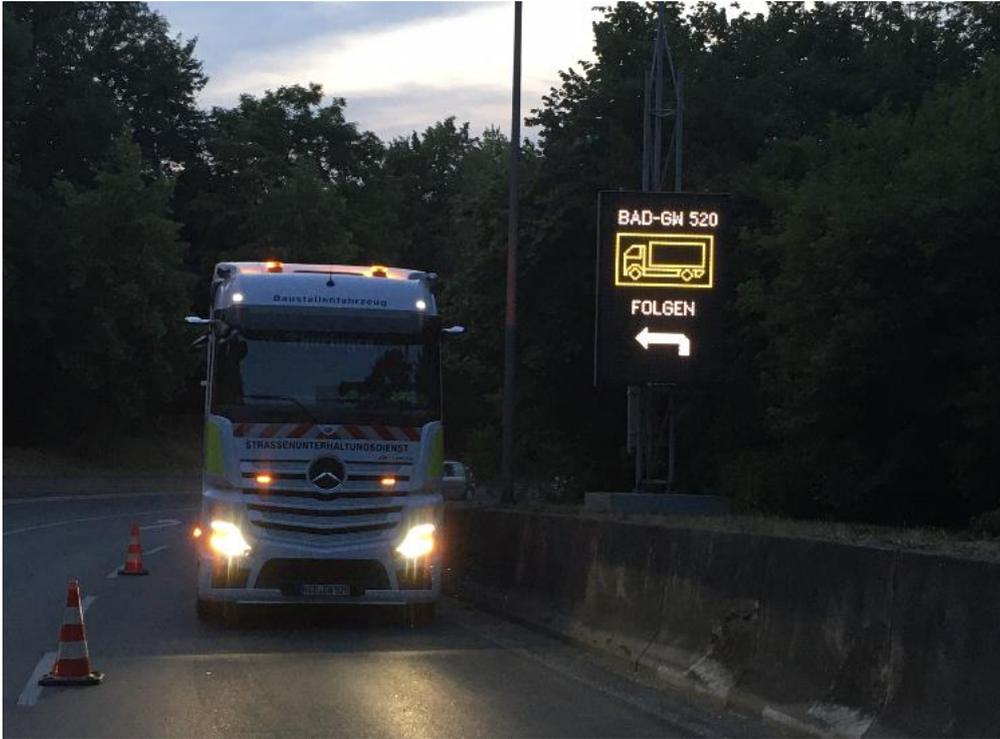
**Abbildung 23:** dynamisches Wechselverkehrszeichen (mit frei programmierbarer Anzeigefläche) im Realbetrieb des Demonstrators
