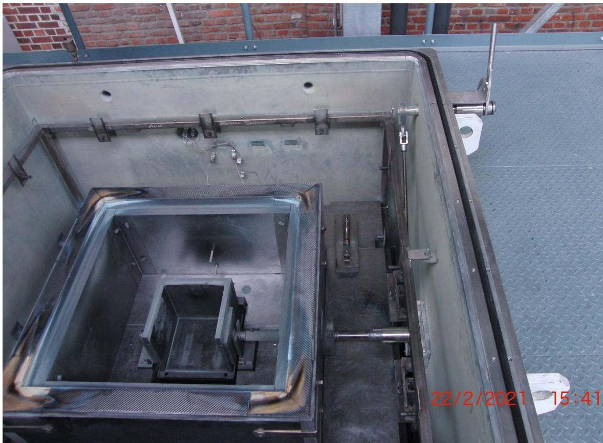
Abb. 34: realisierte Kippvorrichtung in der SCU-G1 Kristallisationsanlage zum Abgießen der Restschmelze
