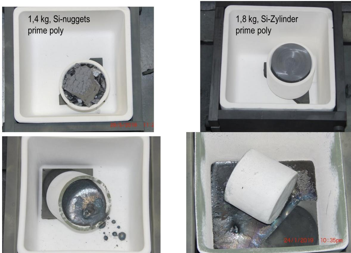
Abb. 31: Verschiedene Typen der Si-Beschickung für Kippexperimente (Links oben: Prime Poly Stücke, Rechts oben: Fz-Vollzylinder), Unten: Endlage der gekippten Tiegel, links in 45° stehen geblieben, recht vollständig umgekippt)
