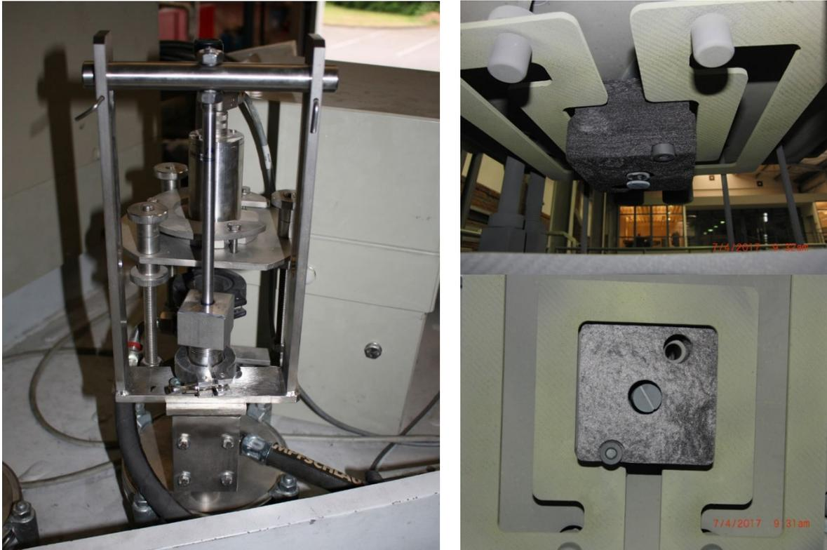
**Abb. 12:** Links: Bedieneinheit (Schubstange) und Vakuumdurchführung der Aufhängung des Grafitfilzes für die Schmelzenabsaugung auf dem Kammerdeckel.
