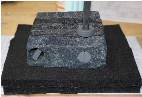
Abb. 16: Kombi-Schwamm bestehend aus höhenreduziertem Hartfilz-Schwamm (oberhalb) und zwei je ~1,4cm dicken Weichfilzschichten (unterhalb).
