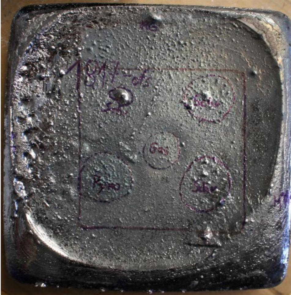
Abb. 22: Oberseite von Block 1817 (6,5kg Silizium-Einwaage), bei dem im zentralen Teil die zum Eintauchzeitpunkt bestehende Fest-Flüssig-Phasengrenze vollständig freigelegt wurde.
