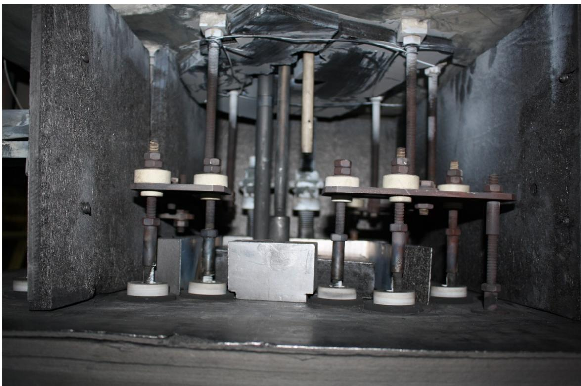
**Abb. 28:** Thermische Isolierung des Absaugbehälters. Oben: Eingebauter Absaugbehälter und thermische Isolation auf seiner Oberseite. Unten: Thermische Abschirmung des (kalten) Kammerdeckels und seitliche Isolation des Raums (in diesem Bild ohne Absaugbehälter).
