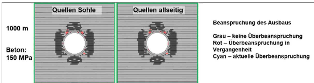
Abbildung 9-13: Starres Ausbausystem unter Berücksichtigung von Quelldrücken (2 MPa) in einer Teufe von 1000 m, Gesteinsfestigkeit 20 MPa
