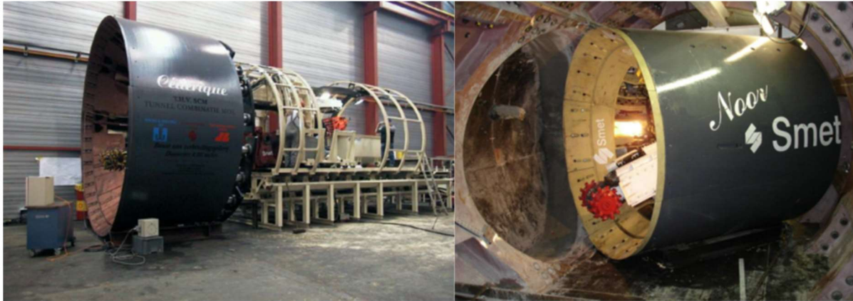
Abbildung 2-24: Vortriebstechnik HADES Connecting gallery (links) und PRACLAY gallery (rechts) (EIG EURIDICE, 2020)
