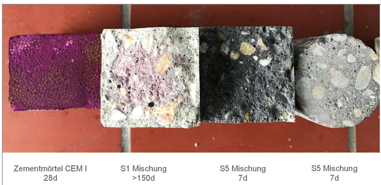
Abbildung 5-15: Phenolphthaleintest an Zementmörtel und LPC
