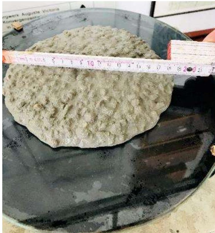
Abbildung 5-7: Haegermann-Ausbreittisch mit Frischbetonkuchen
