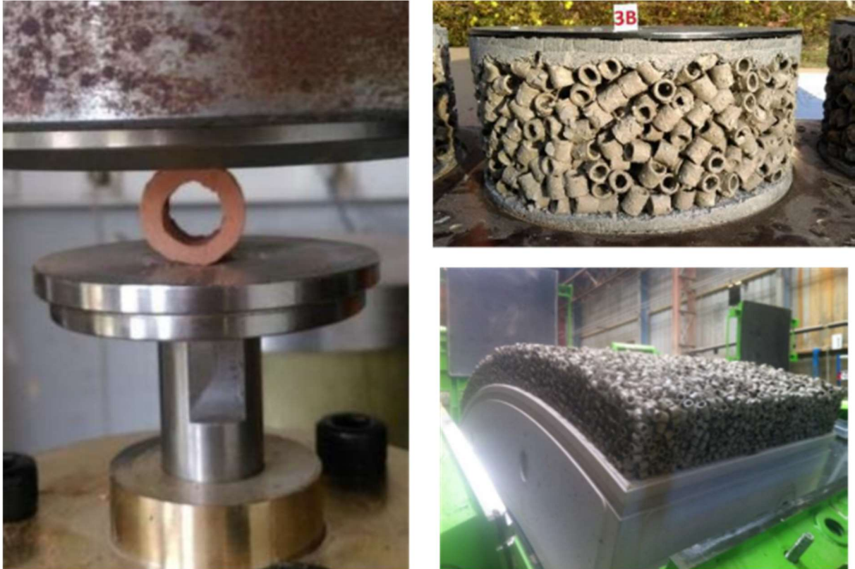
Abbildung 2-46: Tonröhrchen im Druckversuch (links), Probekörper aus vielen Tonröhrchen (rechts oben), Tübbing mit aufgebrachter Schicht aus Tonröhrchen (rechts unten) (Zghondi et al., 2017) und (Ly, 2019)
