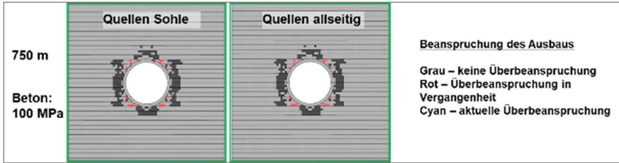
Abbildung 9-12: Starres Ausbausystem unter Berücksichtigung von Quelldrücken (2 MPa) in einer Teufe von 750 m, Gesteinsfestigkeit 20 MPa
