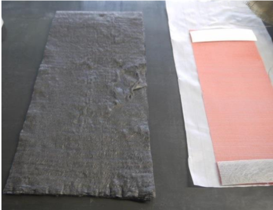
Bild 11: Vorbereitungen zur Vakuuminfusion von C-Faser Vliesen. Im Ausgangszustand bauen die Vliese recht stark auf, erst mit dem Etablieren eines Vakuums werden die Fasern soweit kompaktiert, das die Infiltration mit Harz zu einer verwertbaren Deckhaut führt.
