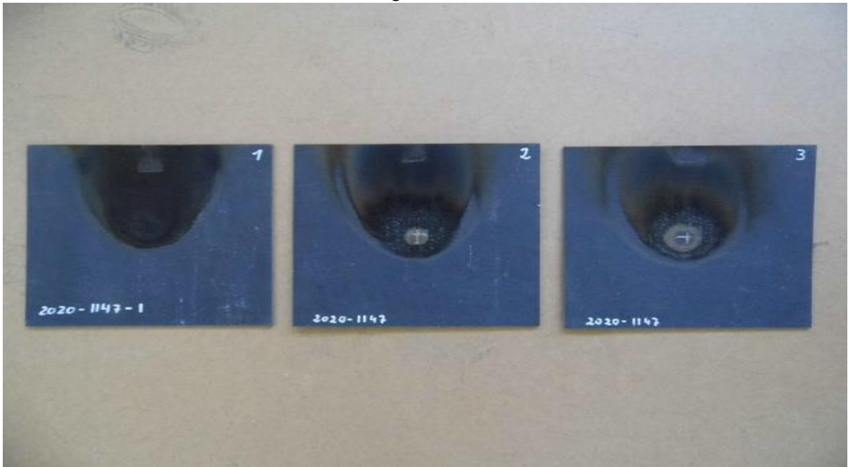
Bild 62: Vorderseite der Proben nach der Beflammung
