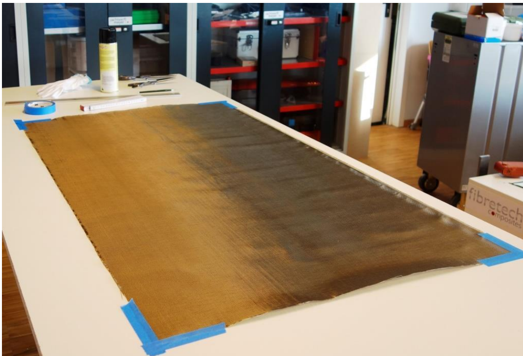
Abbildung119: Ausgangspunkt ist ein Basaltgewebe das mit Zugabe zugeschnitten wird
