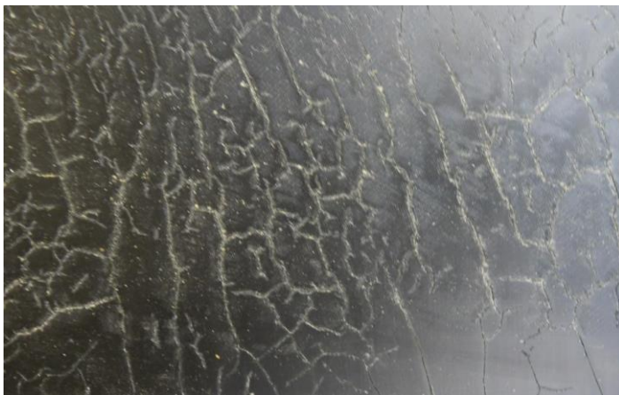
Bild 22: Das dreimalige Erwärmen der Deckhaut zum Aushärten des Harzsystems ergab Spannungsrisse in der Matrix. Grundsätzlich wurde festgestellt, dass das Harzsystem vergleichsweise spröde ausreagiert.
