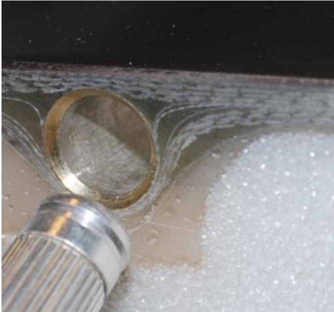
Abbildung 124: Beispiel für den elektrischen Anschluss als Buchse nach dem Besäumen.
