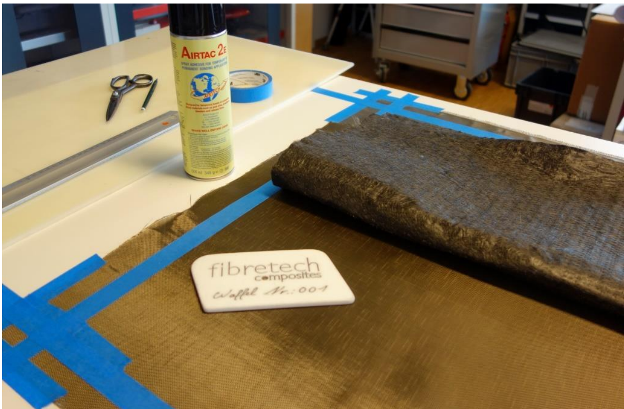
Abbildung 121: Ablage der ersten Heizlage C-Faser Vlies und temporäre Fixierung mit Sprühkleber.
