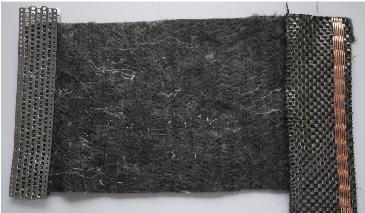
Bild 36: Linke Seite metallisches Klettband, rechts Standard Kontaktierungsband zur Einleitung.
