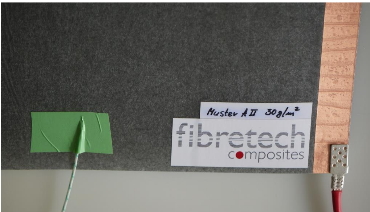
Bild 32: 30 g/m 2 Wirrfaservlies mit einer aufkaschierten Kupferfolie im Kontaktierungsbereich.
