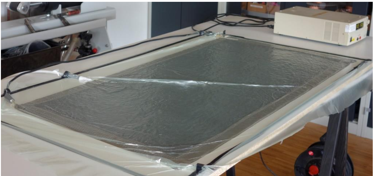
Abbildung 130: Heizungskit im Testaufbau mit Vakuumaufbau
