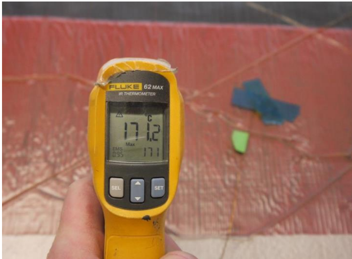
Bild 21: Die notwendigen hohen Temperaturen zur Aushärtung des Harzsystems führten teilweise zur Überlastung der Verbrauchsmaterialien.
