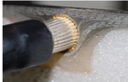
Abbildung 124: Beispiel für den elektrischen Anschluss als Buchse nach dem Besäumen.
