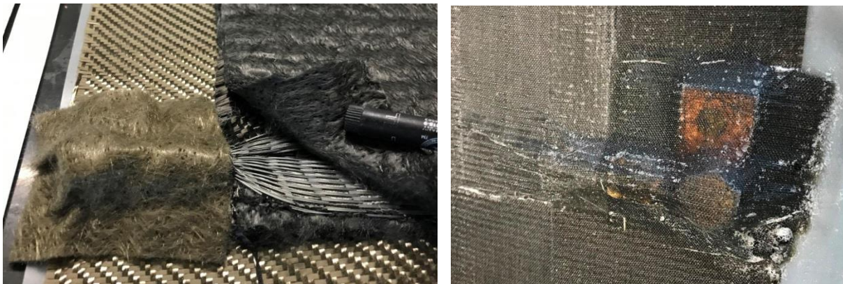
Abb.106 : Elektrische Isolation der Kontaktierung mit Basaltvlies vor und nach der Harzinfusion
