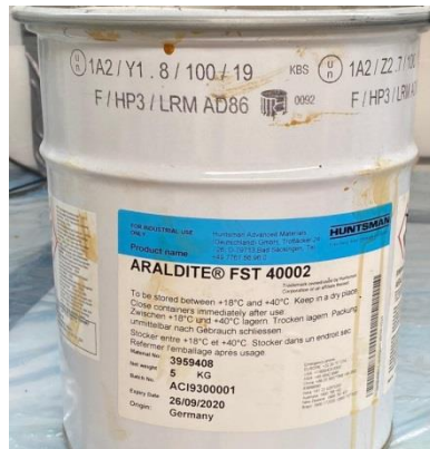
Bild 25 u. 26: Harz- und Härter- Komponente des brandhemmend ausgerüsteten Epoxidharzes
