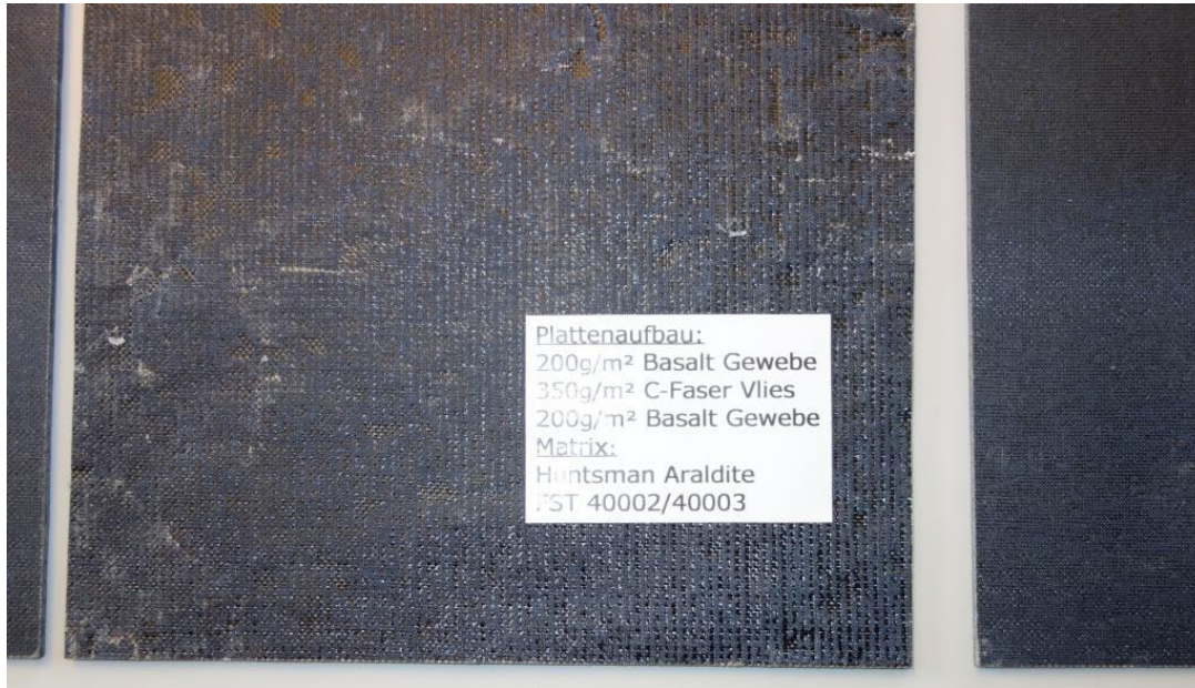
Bild 29: Die hergestellten Platten wurden zu Coupons für den Brandtest besäemt.
