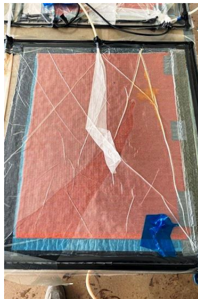
Bild 27u.28: Die Tränkung der Fasern im Vakuuminfusionsverfahren wurde in der Temperkammer durchgeführt um die Prozessvorgaben des Herstellers zu erfüllen.
