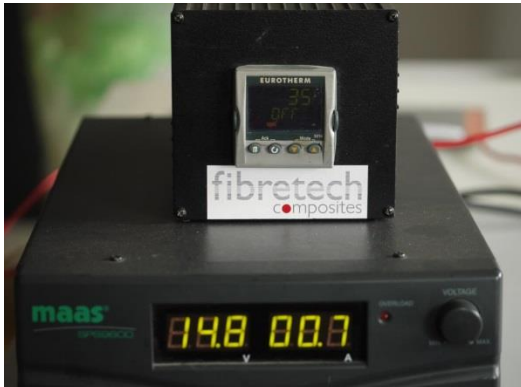
Bild 37 : Testaufbau aus Schaltnetzteil und Regler
