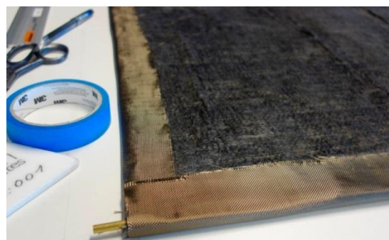
Abbildung 126: Heizungskit vorbereitet für das Vernähen.
