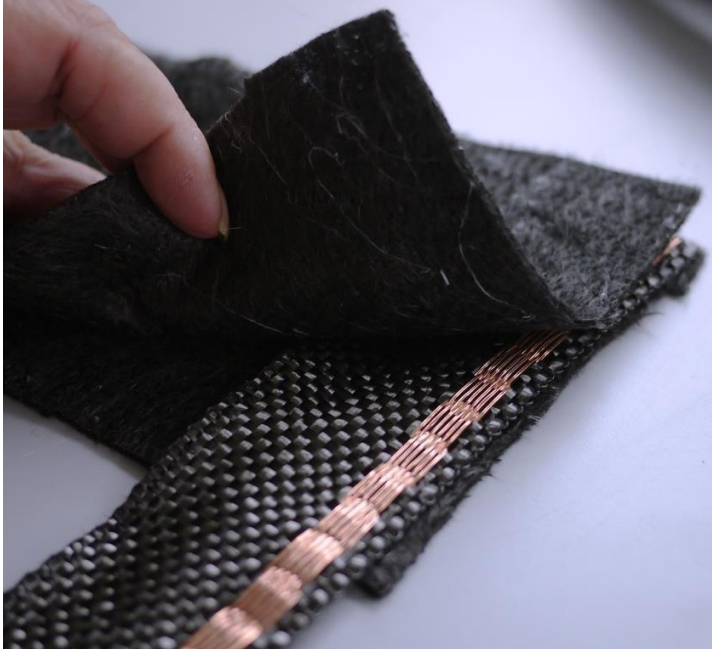
Bild 35 : Kontaktierungsband zwischen zwei Lagen Vlies
