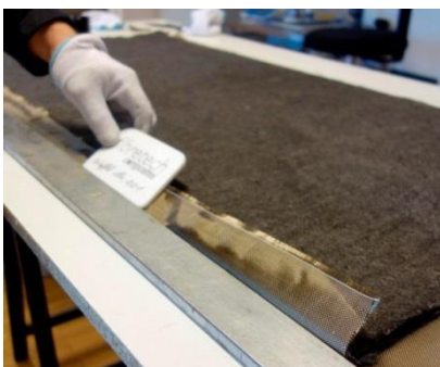
Abbildung 126: Heizungskit vorbereitet für das Vernähen.
