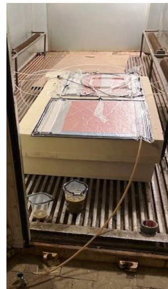
Bild 27u.28: Die Tränkung der Fasern im Vakuuminfusionsverfahren wurde in der Temperkammer durchgeführt um die Prozessvorgaben des Herstellers zu erfüllen.
