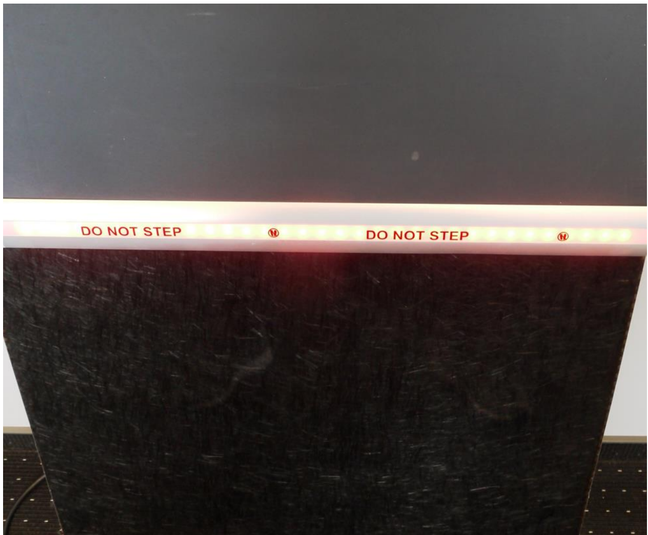
Bild 133: Fußbodenpanel aus recycelten C-Faservliesen; oberhalb der Lichtleiste mit Kraibon Elastomer ausgerüstet
