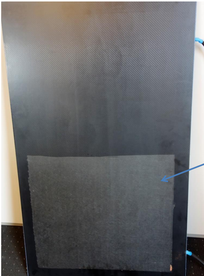
Abbildung 104: Wabensandwichplatte mit Carbonvlies Heizung als erster Demonstrator mit einem „Sichtfenster“ auf die C-Faser Vlies Heizung
