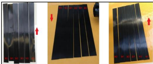
Abb. 29: Gaps und Overlaps bei der Tape-Ablage
