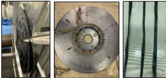
Abb. 38: Ergebnisse der zweiten Imprägnierung der TowPregs mit CTP Hotmeltsystem
