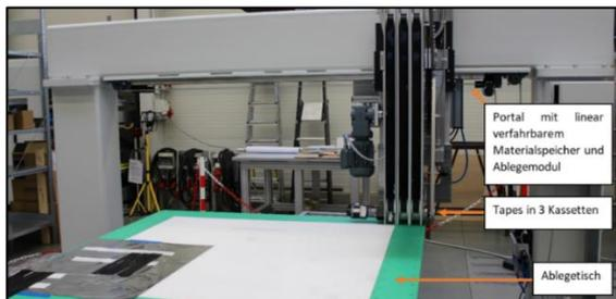
Abb. 19: MAREMO-Legeanlage in Erprobungsphase
