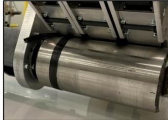
Abb. 36: Förderwalze mit TowPreg und Förderwalze mit PTFE-Klebeband und TowPreg
