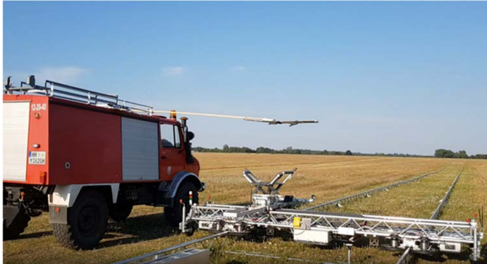
Abbildung 13: Versuchsaufbau mit LARA-Rumpf auf Fahrzeugdach
