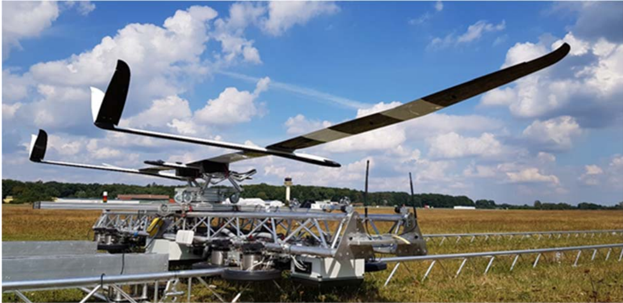
Abbildung 19: LARA auf Bodensystem kurz vor dem automatischen Start
