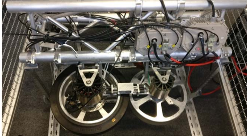
Abbildung 11: Motorprüfstand (MB+P) mit Steuergeräten für Antriebs- (A) und Lastseite (L)
