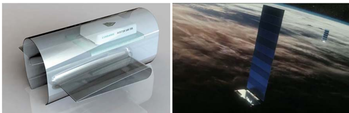
Abbildung 25: Cobham AVIATOR UAV 200 Satcom Antenne (links); Starlink satcom low earth orbit constellation mit hoher Bandbreite (rechts)
