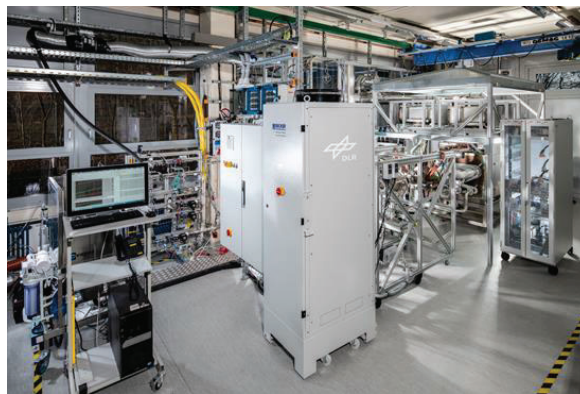
Abbildung 23: Teststands Aufbau mit Sunfire-Stack Unit
