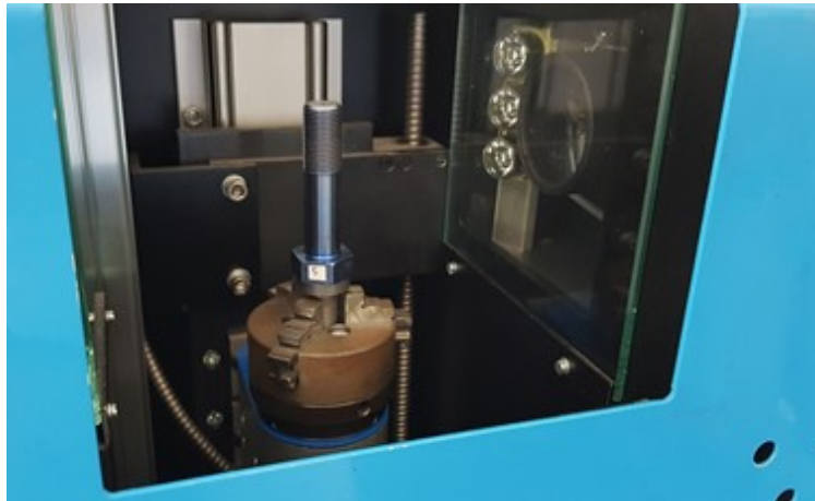
Abbildung 5: Messposition der verwendeten optischen 3D-Messmaschine (Hersteller ECM Datensysteme). Ein Prüfbauteil wird auf den drehbaren Messteller gestellt und von einer Seite mit einem parallelen Strahlbündel beleuchtet. Eine kalibrierte Kamera nimmt den Schattenwurf als Bild auf. Durch Drehung um 360° kann ein Quasi-3D-Scan erzeugt werden. Mittels Kantenerfassungen und Bildanalyse werden die relevanten Bauteilparameter winkel- und orts aufgelöst erfasst und gemeinsam analysiert.
