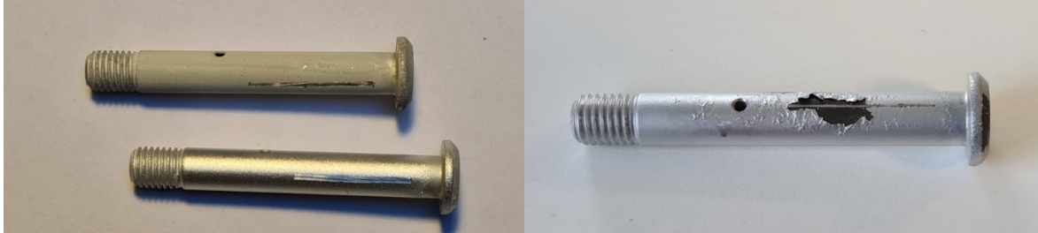
Abbildung 18: Auf Schichthaftung geprüfte Beschichtungen. Links: zwei Proben des IPA, oben im Rohzustand, unten kompaktiert. Rechts: eine Probe mit deutlich abgelöster Schicht der TU Ilmenau im kompaktierten Zustand.
