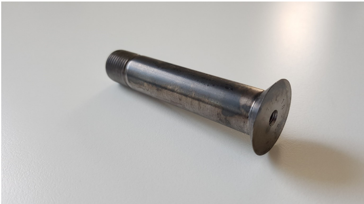
Abbildung 4: Anwendungsnaher Verbinder mit Gewindegröße 0.6250-18 UNJF auf Basis des Standardbauteils EN6114-10 mit M5 Innengewinde im Kopf.
