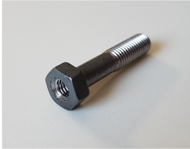
Abbildung 1: Testbolzen mit hochpräzisem Gewinde der Größe 0.2500-28 UNJF mit zusätzlichem M5 Innengewinde im Kopf. Die Gravur der Seriennummer ist zum Zeitpunkt der Fotoaufnahme noch nicht erfolgt.
