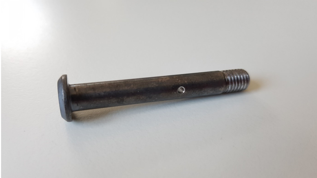
Abbildung 3: Anwendungsnaher Verbinder mit Gewindegröße 0.2500-28 UNJF auf Basis des Standardbauteils EN6115-4 mit zusätzlicher Querbohrung im Schaft sowie M5 Innengewinde im Kopf (nicht sichtbar).
