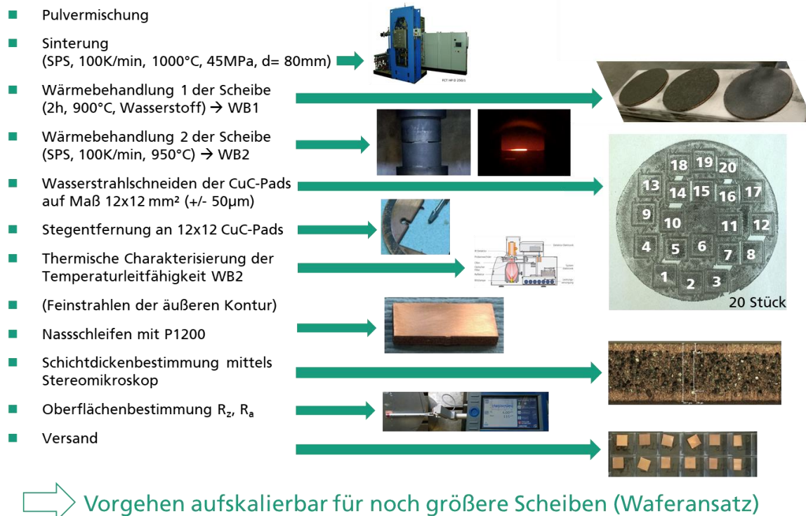
Abbildung 2-57: Erarbeitete Prozesskette zur seriennahen Fertigung von Cu-C-Pads der Generation 2.
