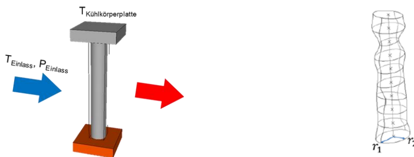
Abbildung 2-2: Einheitszelle der Referenzgeometrie des Pins und Optimierungsfreiheitsgrade.
