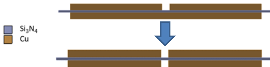
Abbildung 2-20: AMB-Substratkonfiguration für die thermische Partitionierung.
