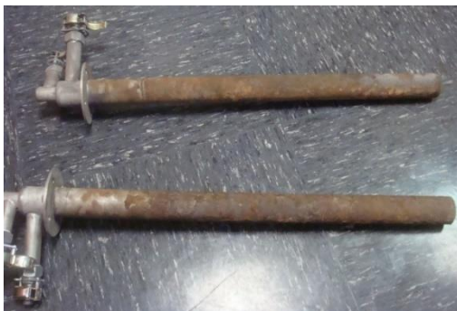
Abbildung 1-1: Foto der wassergekühlten Stützrohre nach ihrem Einsatz.
