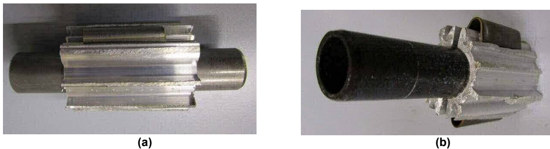
Abbildung 4-12: TESIN Proben für die Abzugsversuche (a) vor der Auslagerung und (b) nach der Auslagerung und dem Abzug.
