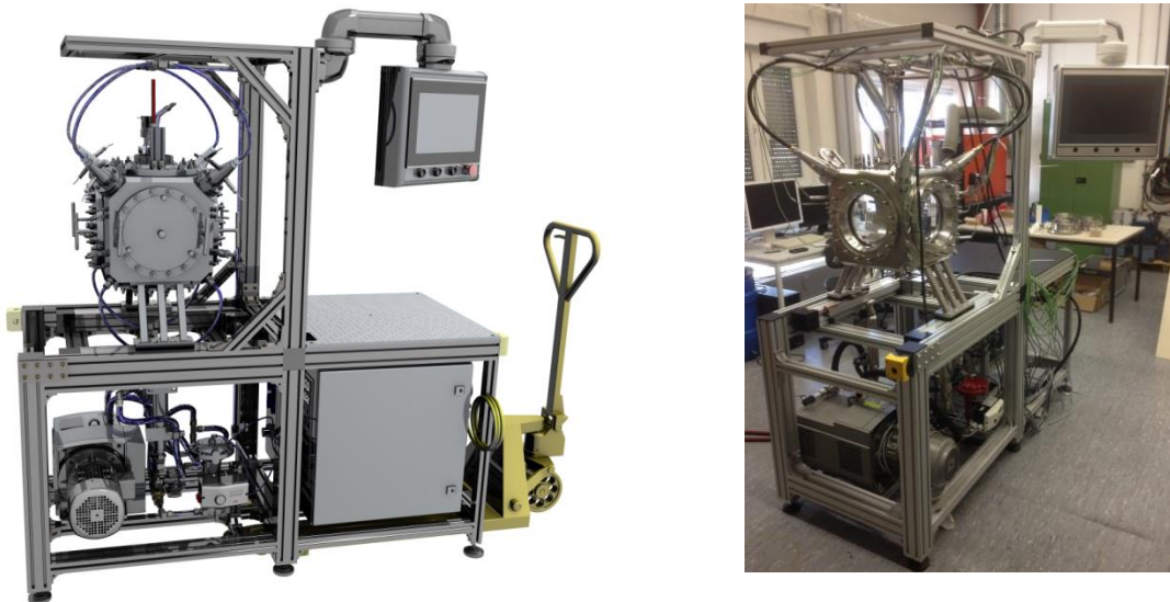
Abbildung 2.4.6: Gesamtansicht mobile Spraykammer CAD Modell
