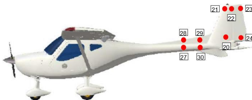
Abbildung 6.38: Verteilung der Beschleunigungssensoren in der Seitenansicht
