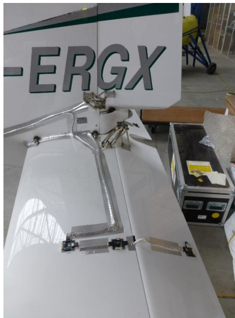
Abbildung 6.39: Beschleunigungssensoren am Leitwerk der D-ERGX
