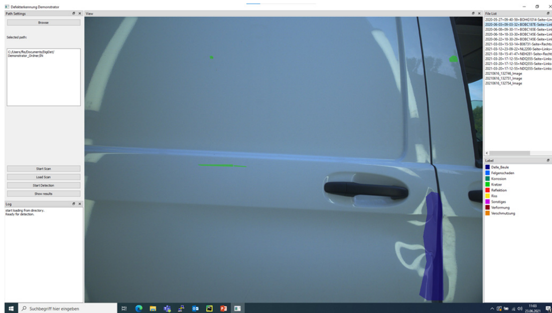
Abbildung 14: Entwickelte grafische Bedienoberfläche zur Anzeige der erkannten Fahrzeugschäden, hier Dellen an der Tür in dunkelblau markiert, Kratzer in hellgrün.
