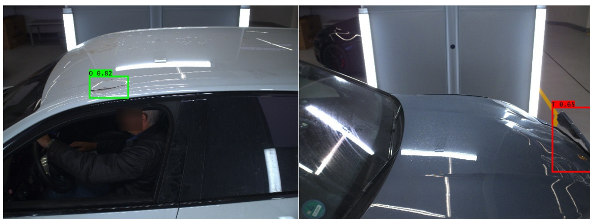
Abbildung 13: Bildhafte Auswertung und Reflexion sowie Schattenwurf auf den Fahrzeugen
