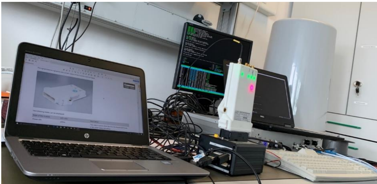
Abbildung 51: Versuchsaufbau des Schnittstellentests des Radio Board der OBU beim Fraunhofer HHI
