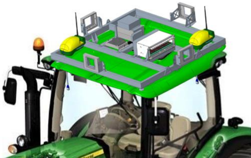
Abbildung 56: Dachträger zur Aufnahme von Versuchskomponenten
