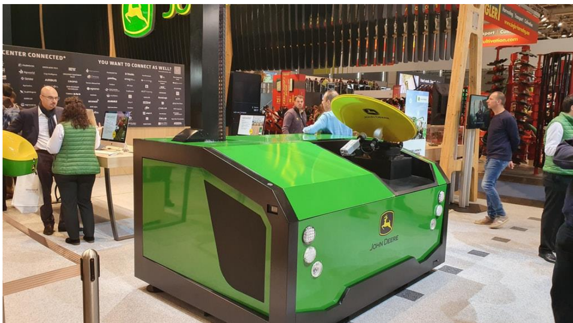
Abbildung 68: Mobile LTE/5G-Basisstation mit integrierter Edge-Cloud auf der Agritechnica 2019 („Mobile Communication Center – MCC“)
