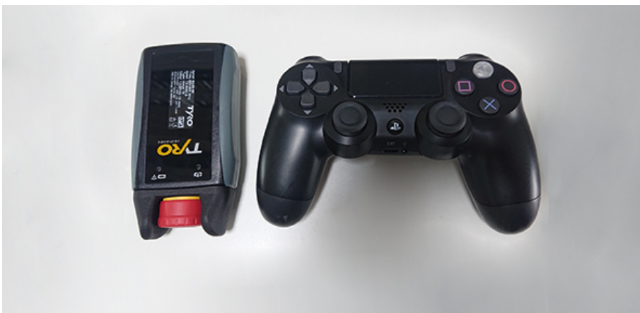
Abbildung 18: Funk-Not-Stopp-Taster und Bluetooth-Controller
