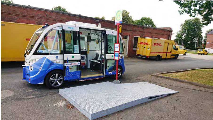
Abbildung 35: Haltestelle am Posteinlagerungszentrum mit einem temporär eingesetzten Kunststoffpodest
