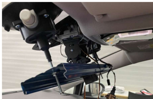
Abbildung 25: Kamera auf 2-Achsgimbal
