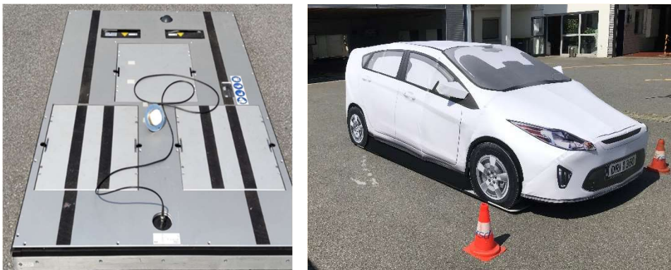
Abbildung 32: Humanetics UFOpro und DRI Global Vehicle Target
