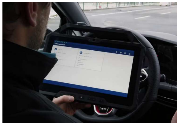
Abbildung 56: Im Projekt ErVast erarbeitete Steuerung des Prüfablaufes mit Hilfe eines Bedien- und Anzeigerätes
