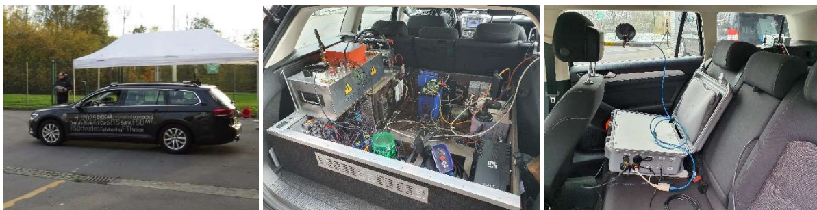
Abbildung 31: FSD.Labcar mit automatisierten Fahrfunktionen und zusätzlicher Umfoldsensorik
