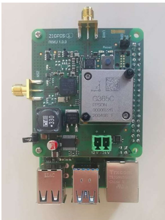
Abbildung 27: Prototyp des entwickelten ZIGPOS CarPC mit UWB Lokalisierung und IMU als Shield für RaspberryPi
