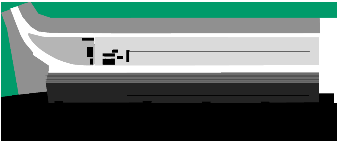
Abbildung 3: Rasterkarte der Hafenumgebung. Unbeschränkte Befahrbarkeit wird repräsentiert durch weiße Grauwerte, eingeschränkte, bzw. nicht befahrbare Bereiche werden durch dunklere, bzw. schwarze Grauwerte definiert
