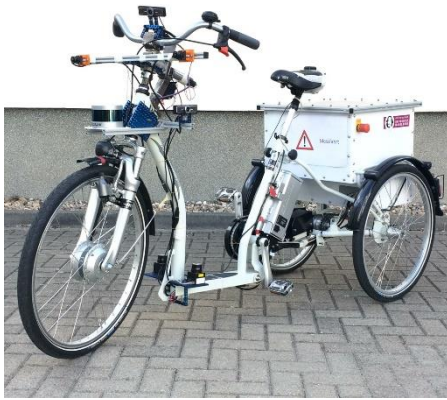
Abbildung 1: Konfiguration des dreirädrigen Messträgers A für die ferngesteuerte Datenaufnahme
