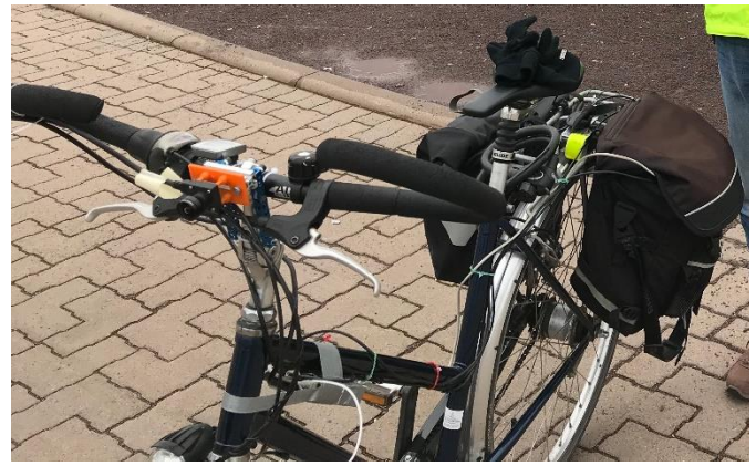
Abbildung 2: Konfiguration eines Messträgers für die manuell getriebene Datenerfassung
