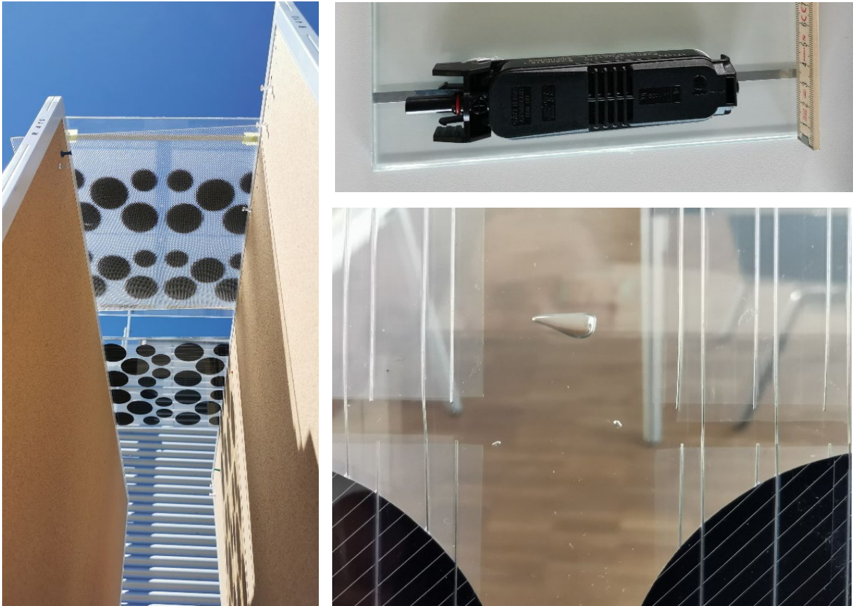
Abbildung 24: Analysen zu Schattenwurf bei unterschiedlichen Glasoberflächen und Betrachtungen zu Prozessqualität bei Luft einschüssen und zu Transparenzunterschieden bei der Überlappung der Trägerfolien.
