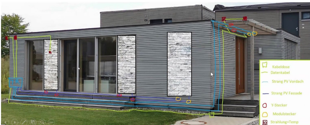
Abbildung 44: Strangschema der Kabelführung incl. Modulanschlüsse und Sensorik
