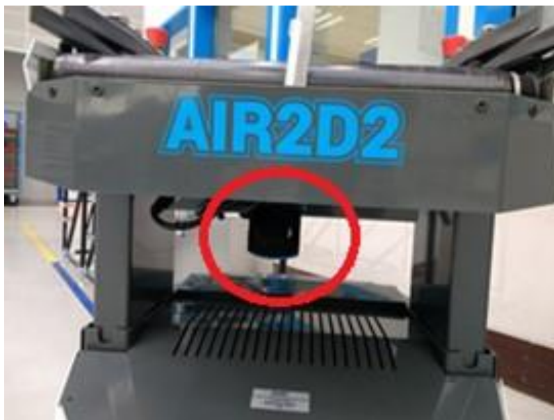
Abbildung 11: Sensornachrüstung am Open Shuttle 50
