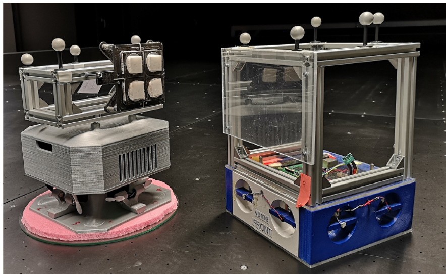
Abbildung 3.2.: Verwendete Mockups für die Dockingexperimente, Chaser (links) und Target (rechts). Am oberen Rand der Mockups sind die zur Positionserfassung nötigen Tracker zu erkennen.
