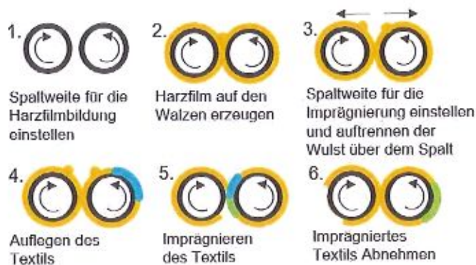
Abbildung 6: Schematische Darstellung der zweiseitigen Imprägnierung (zIP)
