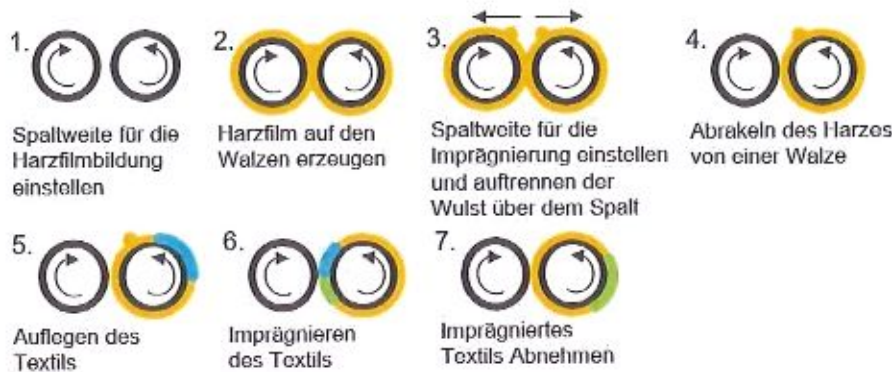
Abbildung 8: Schematische Darstellung der einseitigen Imprägnierung (eIP) am IWW TUHH
