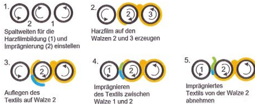
Abbildung 9: Schematische Darstellung der einseitigen Imprägnierung (eIP) an Dreiwalzwerk
