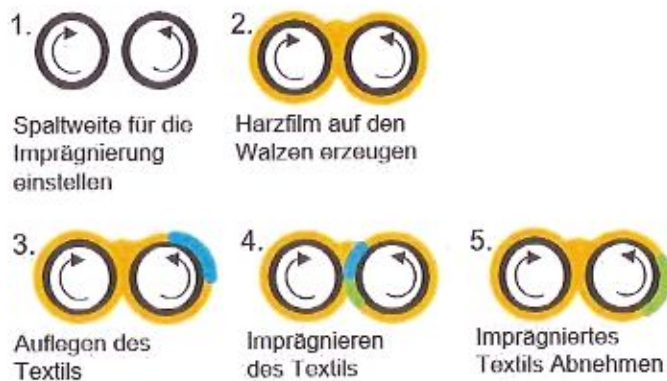
Abbildung 4: Schematische Darstellung des überfüllten Spaltes (üSP)
