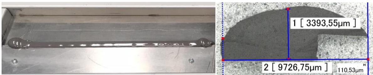
**Abbildung 19: Applizierter Dichtstoff auf Probeblech (links) und Querschnitt der Klebung (rechts)**
