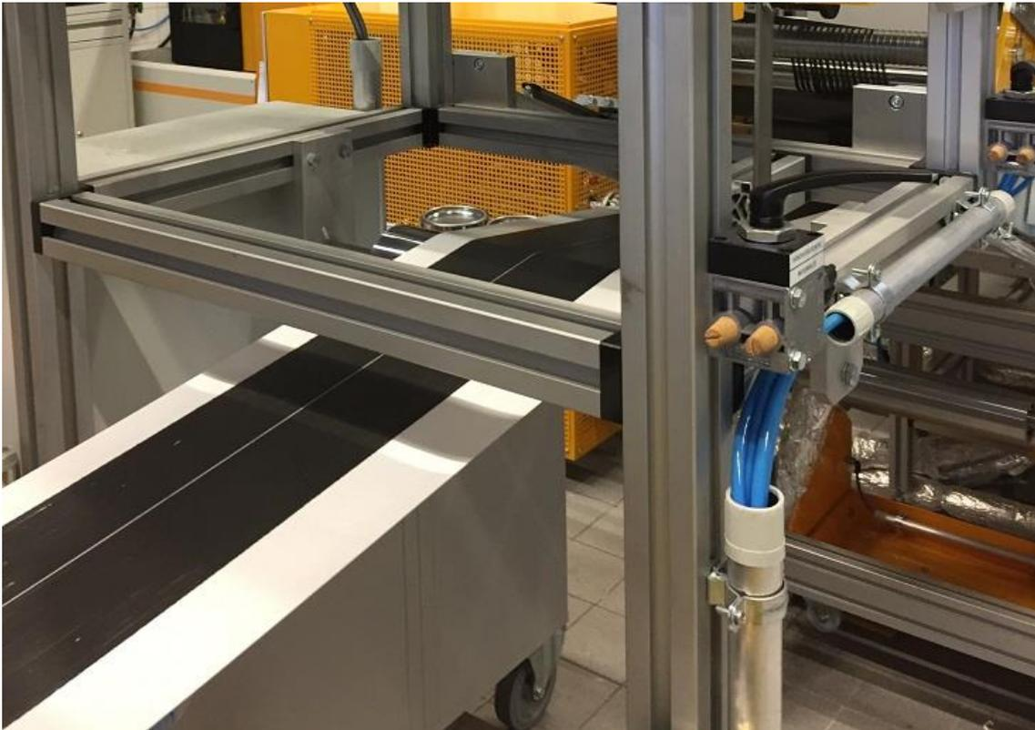
Abbildung 10: Prepreg-Herstellung mit Graphit-modifiziertem Harzsystem
