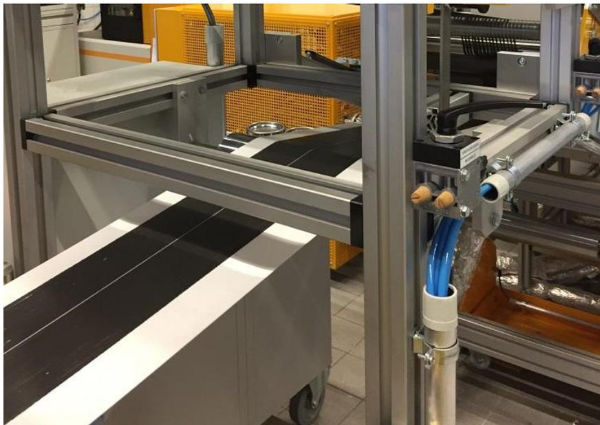
Abbildung 14: Prepreg-Herstellung mit Graphit-modifiziertem Harzsystem
