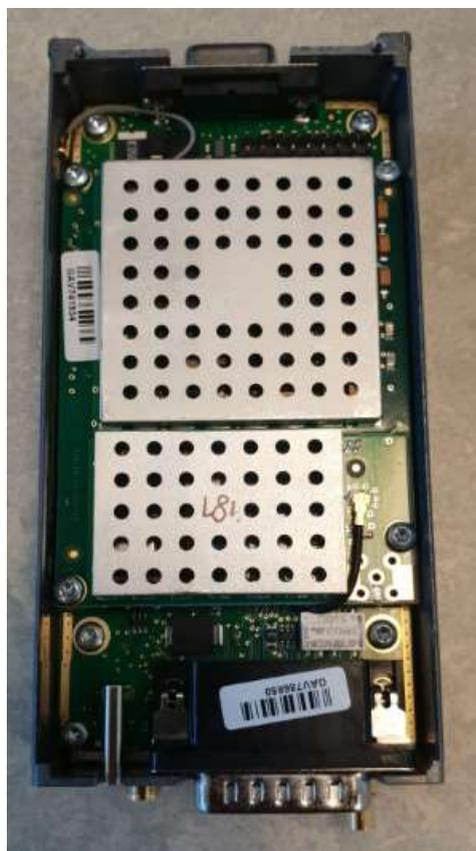
Abbildung 10: AirTraffic AT-1 (Seriengerät im LRU Gehäuse)
