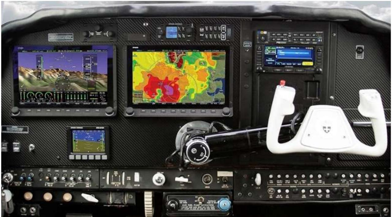
Abbildung 3: Integrierte Cockpitlösung Dynon SkyView (Quelle: AOPA)
